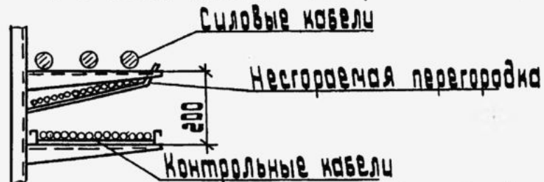
Рис. 6 Силовые кабели и контрольные кабели в пучках
