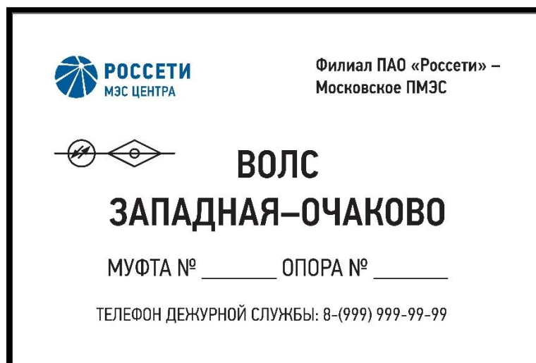
Рисунок 9.6. Пример информационного знака муфт оптического кабеля ВОЛС (размер 300x200 мм)
