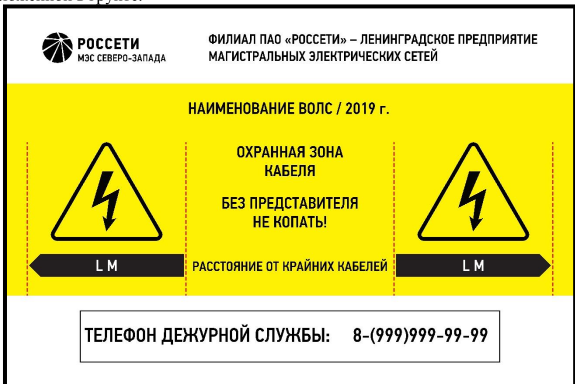
Рисунок 9.5. Пример информационного знака, устанавливаемого на трассе ВОЛС, проложенной в грунте (соотношение сторон 3:2, размер 450x300 мм)
