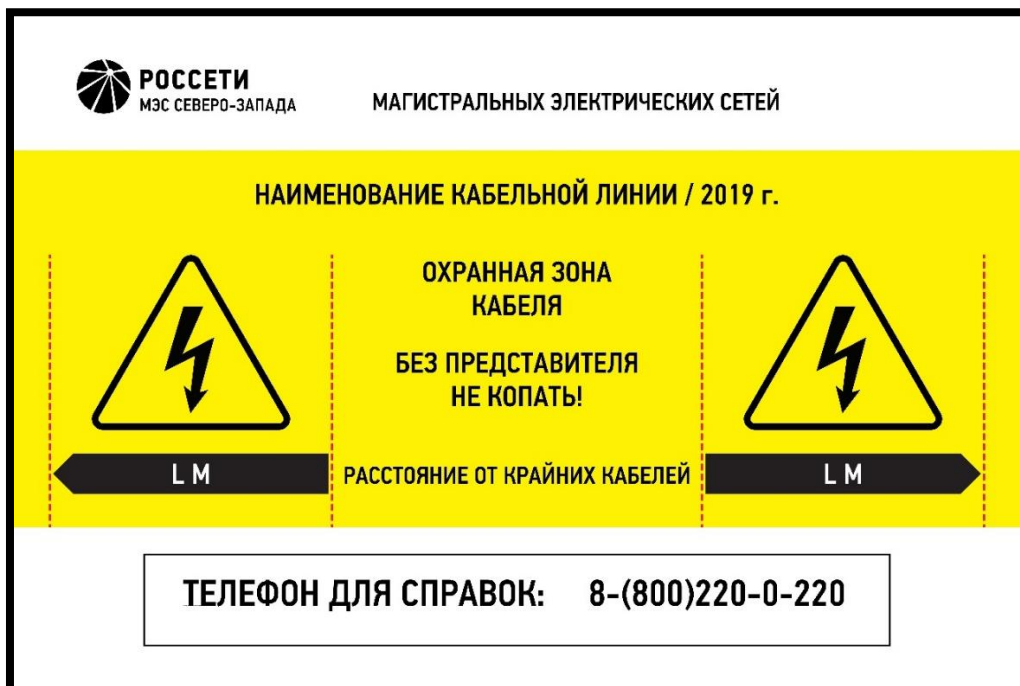
Рисунок 9.4 Пример информационного знака КЛ (соотношение сторон 3:2, размер 450x300 мм)
