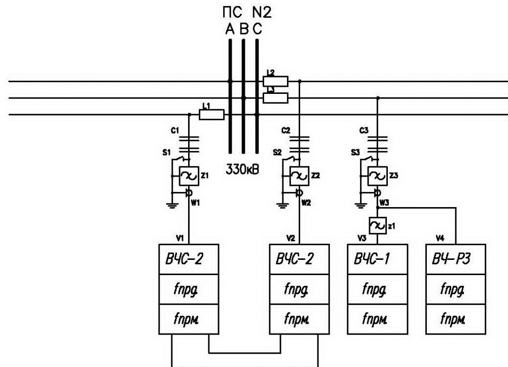
Рис. 7 "Жесткий" переприем и параллельная работа
