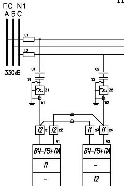
Рис. 6 Присоединение "фаза–фаза" аппаратуры с раздельным исполнением приемника и передатчика.
