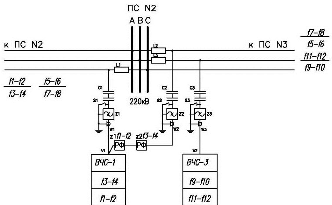
Рис. 9 ВЧ обход подстанции с ВЧ каналом, оканчивающимся на ПС ВЧ обхода.
