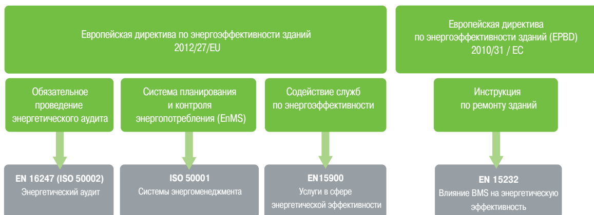
Рис. К1б. Соответствие между европейскими нормами (в зеленом цвете) и стандартами (в сером цвете)
