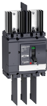
Рис. P14. Выключатель-разъединитель Compact NSX 200 А с межфазными перегородками и контактными пластинами с теплоотводами
