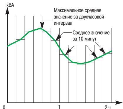
Рис. С10. Максимальное среднее значение мощности за двухчасовой период
