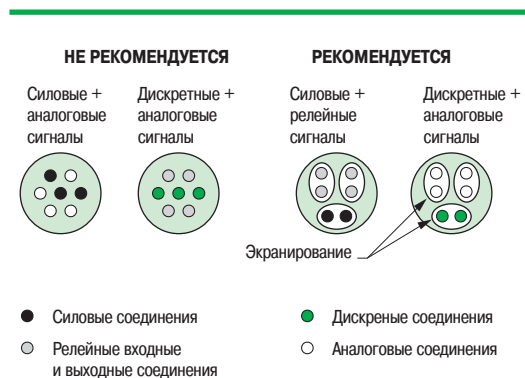
Рис. R40. Несовместимые сигналы = разные кабели
