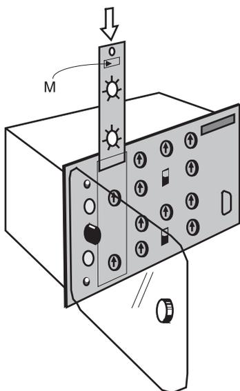
Задвиньте этикетку применяемой шкалы за прозрачную часть передней панели.
