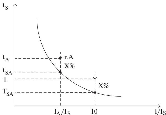
**Задача** *Выбрать тип обратнозависимой кривой и время срабатывания  $T$  (при  $I = 10 \cdot I_S$ ) 1-ой ступени МТЗ р/к.
