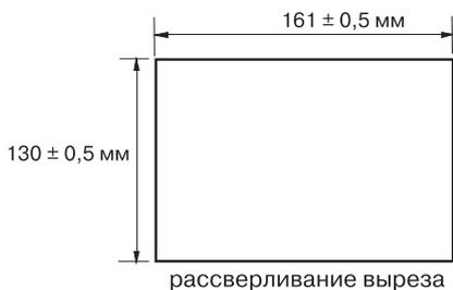
Реле VIP300 монтируется заподлицо в прямоугольном вырезе, сделанном в металлической панели толщиной не более 3 мм.
