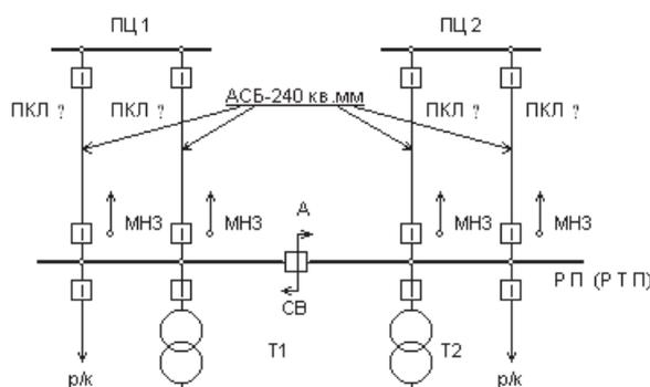
Схема при применении ПКЛ с трехфазным кабелем с пропитанной бумажной изоляцией типа АСБ-240 мм<sup>2</sup>
