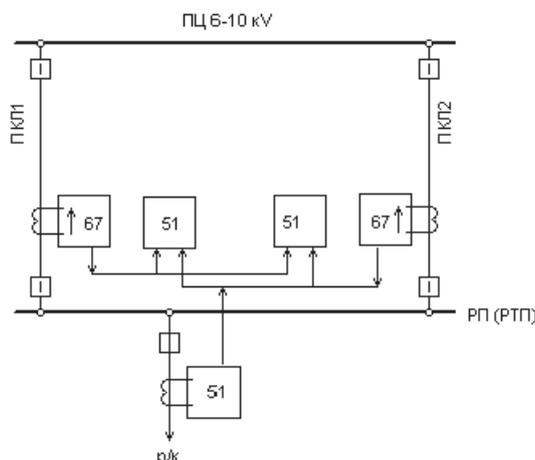
Для предотвращения ошибочного отключения обеих ПКЛ при повреждении одной из них логическая селективность должна быть организована следующим образом:
