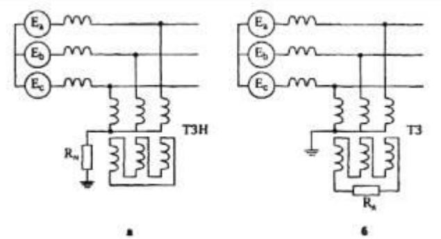
Рисунок 1 - схемы подключения резистора к нейтрали сети
