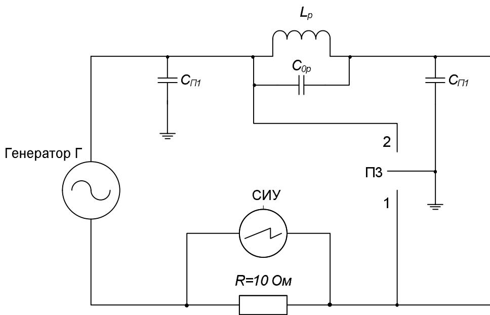
Рисунок 4.9. Схема измерений частоты собственного резонанса реактора
