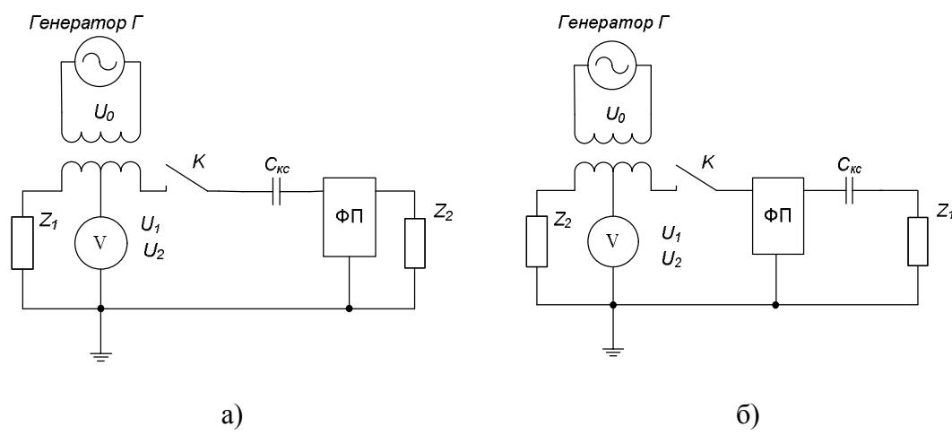
Рисунок 3.3. Схема измерения затухания несогласованности ФП.
