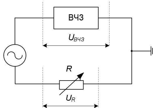
Рисунок 4.3. Схема измерения модуля полного сопротивления ВЧЗ
