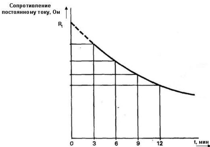
Рисунок 4.5. График зависимости измеренных значений сопротивления от времени
