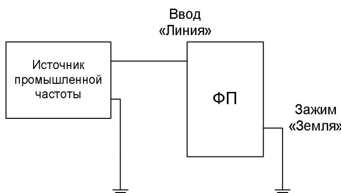
Рисунок 3.4. Схема измерения изоляции ввода «Линия» ФП
