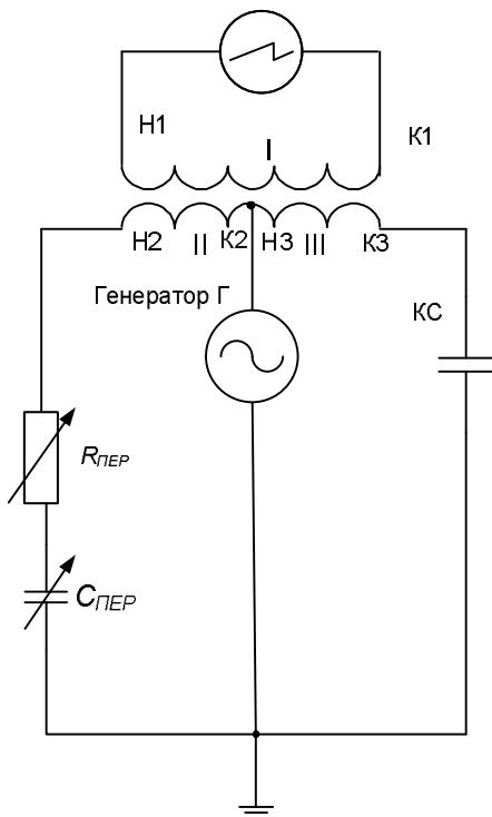
Рисунок 5.2. Схема измерения упрощённой схемой моста
