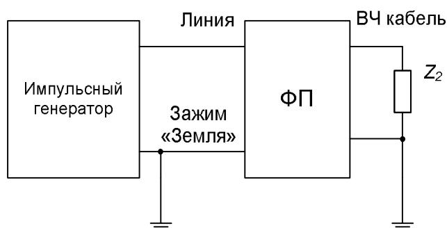
Рисунок 3.7. Схема измерения импульсной прочности входа «Линия» ФП
