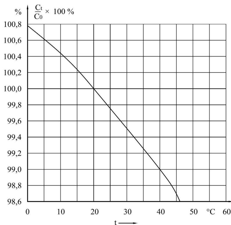
Рисунок 5.1. График зависимости ёмкости от температуры.  $C_t$  – ёмкость при температуре  $t$ ,  $C_0$  – ёмкость при температуре  $20^\circ\text{C}$
