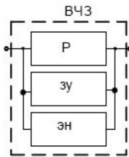
Рисунок 4.1. Блок-схема высокочастотного заградителя
