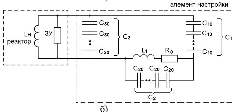
Рис. П2.4 двухчастотная а) резонансная, б) притупленная.
