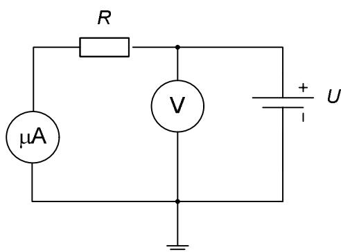
Рисунок 5.4. Измерение активной проводимости между выводом низкого напряжения и выводом «Земля». U – источник напряжения постоянного тока,  $\mu\text{A}$  – микроамперметр, V – электрический вольтметр, R – испытуемый конденсатор или подставка
