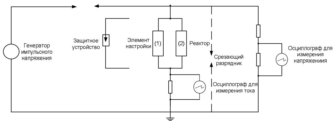
Рисунок 4.4. Схема испытаний прочности изоляции заградителя импульсным напряжением
