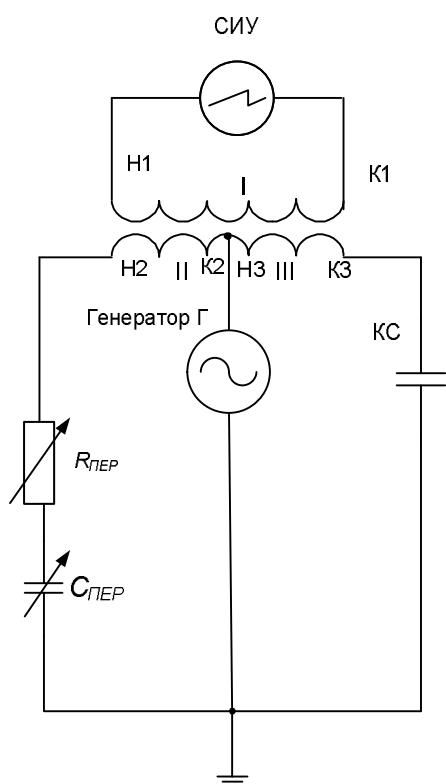
Рисунок 4.2. Схема упрощенного моста при измерениях заграждающего сопротивления
