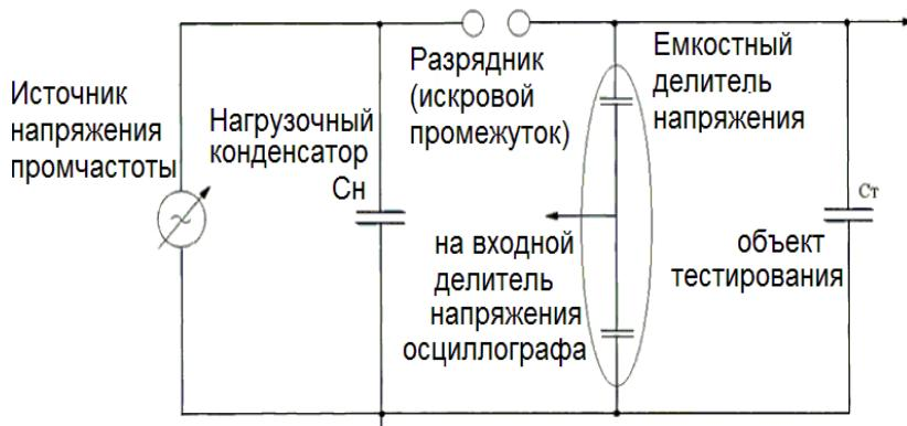
Рис. П2.6 Схема испытательной установки.
