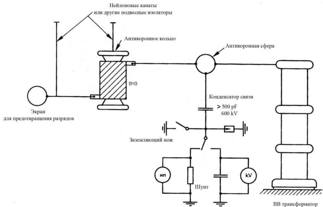
Рисунок 4.7. Схема измерения напряжения радиопомех, генерируемых ВЧЗ
