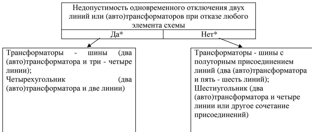
\* При шести и более присоединениях и невозможности или нецелесообразности использования по тем или иным причинам схем трансформаторы - шины, трансформаторы - шины с полуторным присоединением линий или шестиугольник необходимо перейти к рассмотрению наиболее затратной (требующей при прочих равных условиях наибольшего количества ячеек выключателей) полуторной схемы.
