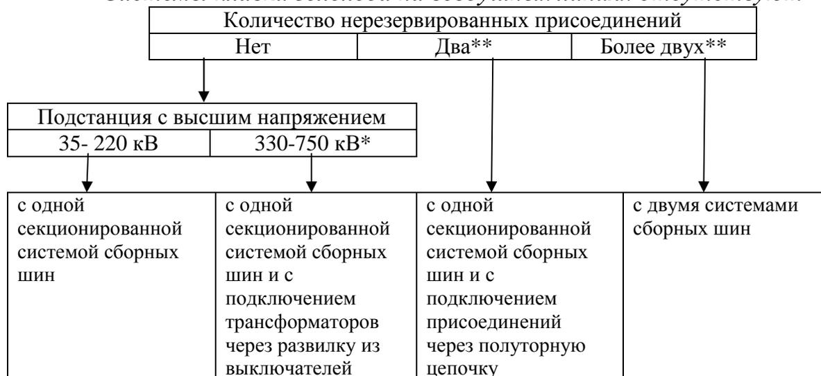
\* РУ 35 - 220 кВ подстанции с высшим напряжением 330 - 750 кВ (т.е. сторона среднего напряжения).
