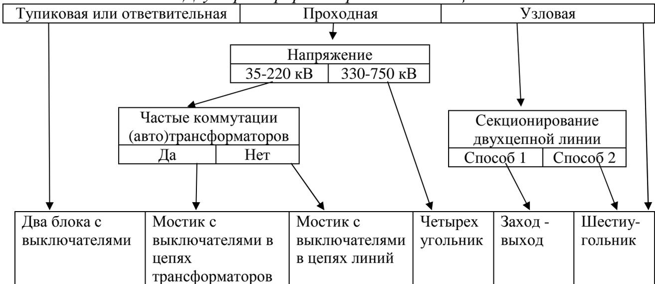
Примечание: Способы секционирования двухцепной линии могут быть двух типов. Первый тип - использование схемы заход - выход, второй способ - схемы шестиугольника. В последнем случае параллельные линии имеют непосредственную электрическую связь, что обеспечивает более равномерное естественное потокораспределение активной мощности. Это благоприятно сказывается на потерях мощности и энергии в электрических сетях.
