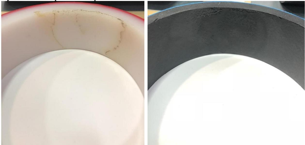
Б.6. Оценка результатов проверки делается не только по внешнему виду трубы после окончания воздействия пламени, но и по поведению трубы непосредственно в момент воздействия пламени. Поэтому в рамках проверки следует проводить и фото, и видеофиксацию.
