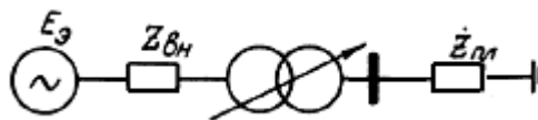
Рис. П4.1. Расчетная схема для определения тока плавки от УПГ с преобразователем, питающимся от блока АТ-ВДТ
