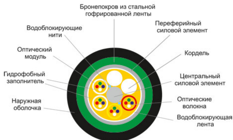
Рисунок 12. Пример конструкции ВОК для прокладки в зданиях
