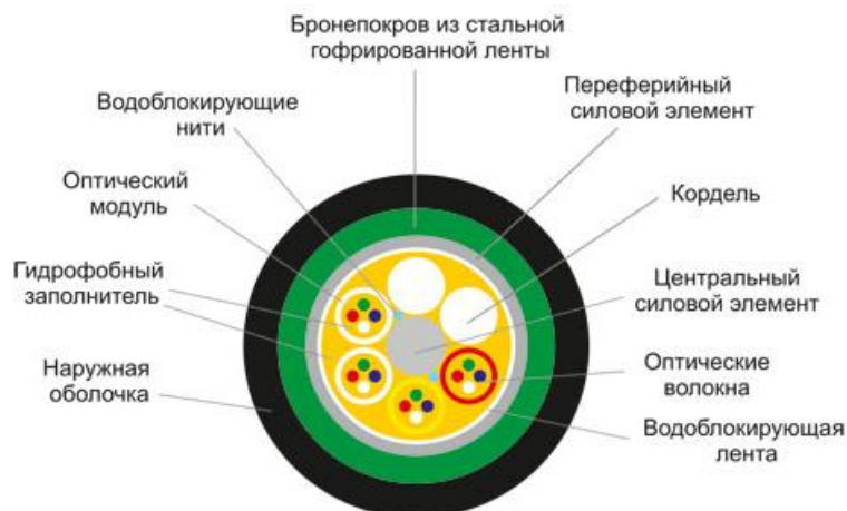
Рисунок 12. Пример конструкции ВОК для прокладки в зданиях
