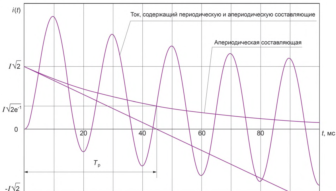
Рисунок Б.2 — Ток при коротком замыкании в сети
