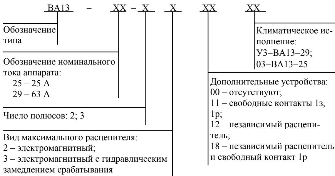
Рис. 2.89. Структура условного обозначения выключателей серии ВА13
