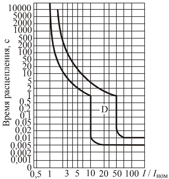
Рис. 2.165. Защитная характеристика автоматических выключателей BA-101, BA-102 и BA-201 с D-типом электромагнитных расцепителей
