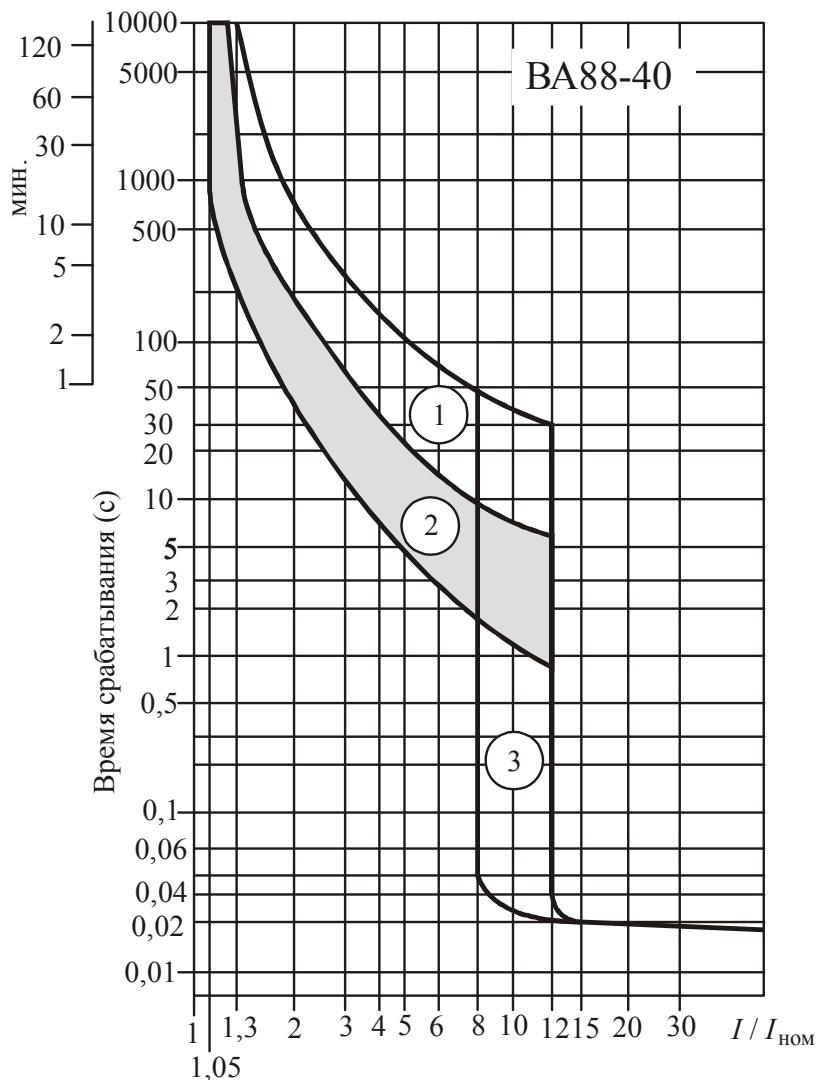
*Рис. 2.144. Времятоковая характеристика автоматического выключателя BA88-40: 1 – из холодного состояния; 2 – из нагреветого состояния; 3 – зона срабатывания электромагнитного расцепителя*
