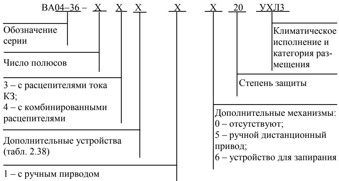
Рис. 2.79. Структура условного обозначения выключателей серии ВА04–36
