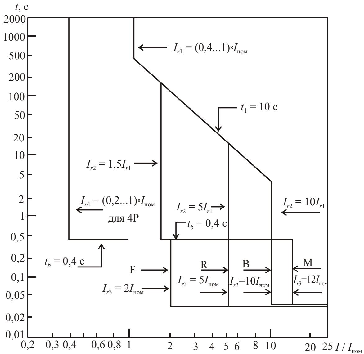
Рис. 2.56. Времятоковая характеристики автомата BA88-43 с электронным (микропроцессорным) расцепителем при отключении по  $I^2 \cdot t$
