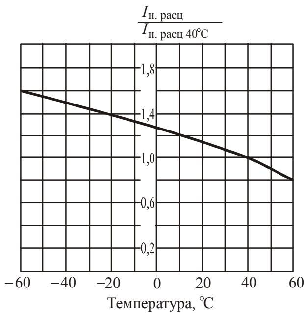
Рис. 2.87. Зависимость номинального тока выключателя (расцепителя), выраженного в кратностях к номинальному току при  $40^{\circ}\text{C}$ , от температуры окружающей среды
