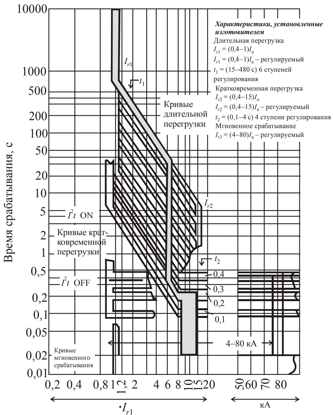
Рис. 2.22. Времяточевые характеристики автоматических выключателей BA-45/5000 с микропроцессором типа М, Н
