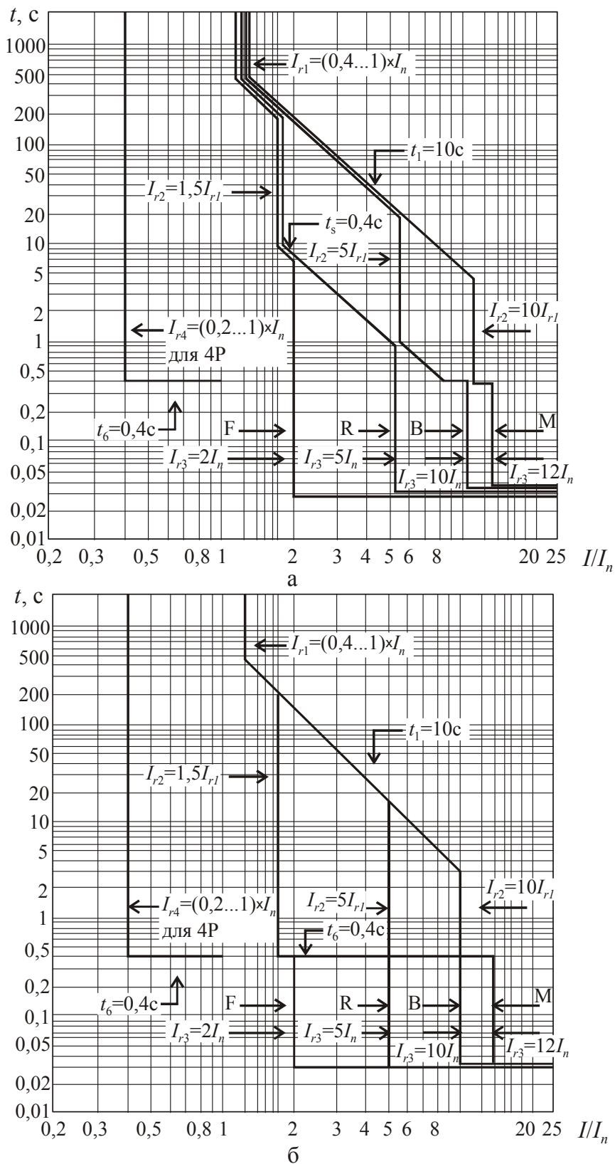
Рис. 2.58. Времяточковые характеристики автоматических выключателей BA-99/1600 с микропроцессорным расцепителем: а – характеристика расцепителя при включении по  $I^2 \cdot t$ ; б – характеристика расцепителя при отключении по  $I^2 \cdot t$
