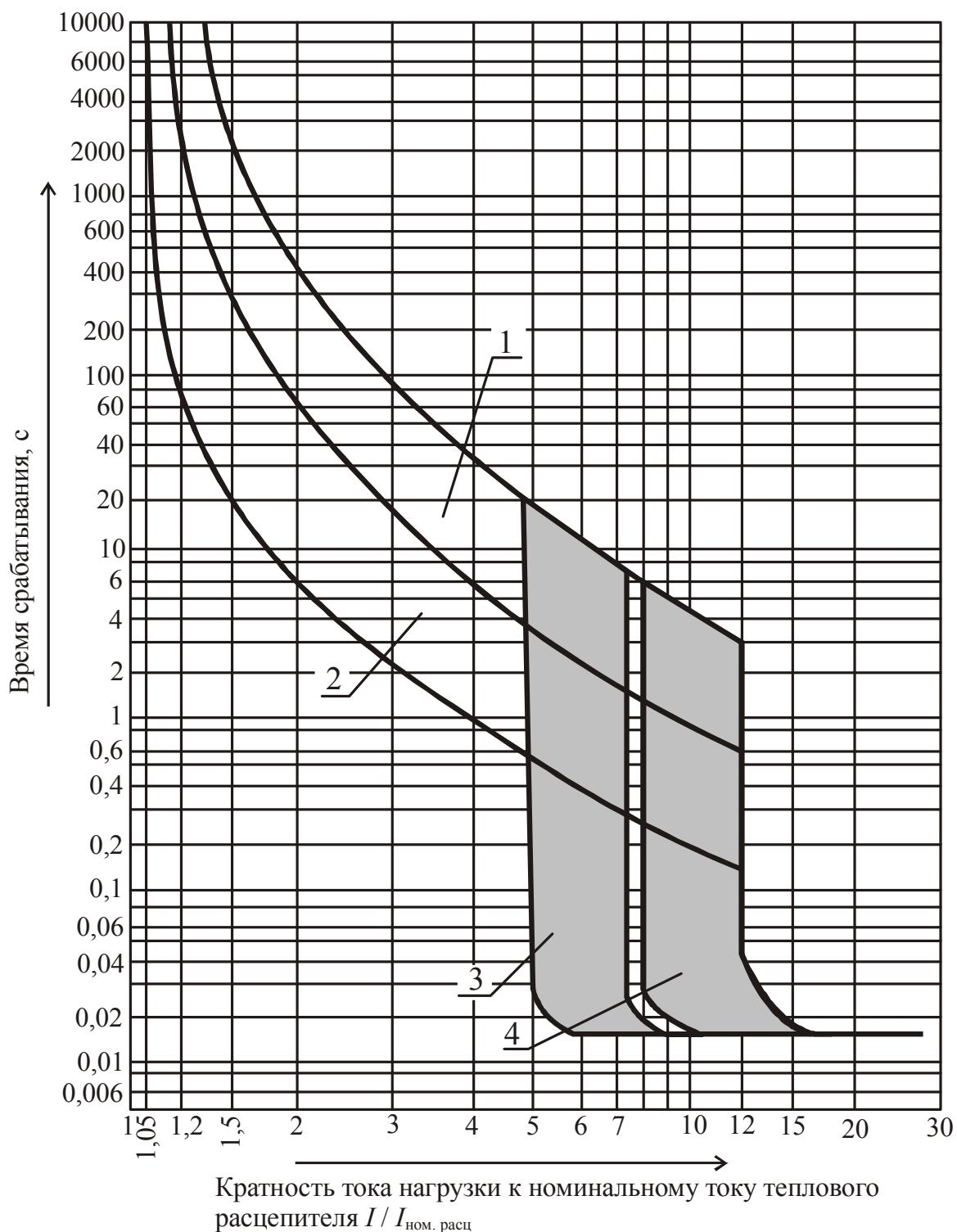
Рис. 2.115. Времятоковые характеристики BA51 39, BA52 39: 1 – времятоковая характеристика с холодного состояния; 2 – времятоковая характеристика с нагретого состояния; 3 – зона работы электромагнитного максимального расцепителя тока при постоянном токе; 4 – зона работы электромагнитного максимального расцепителя тока при переменном токе
