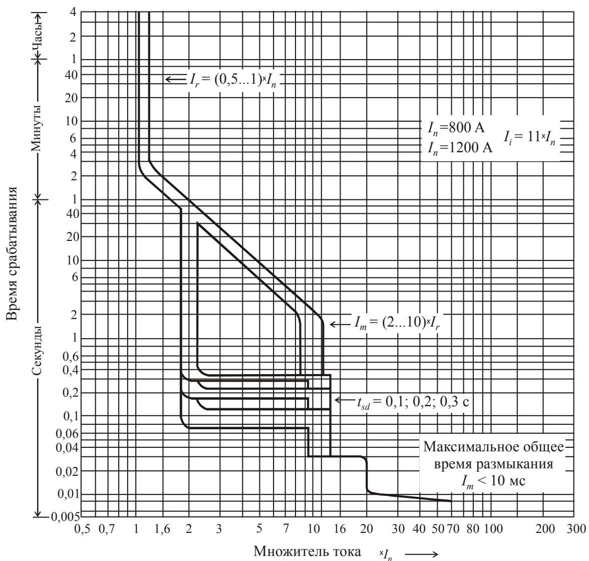
Рис. 2.69. Времяточковые характеристики отключения автоматического выключателя BA-СЭЩ-ABS1203Е
