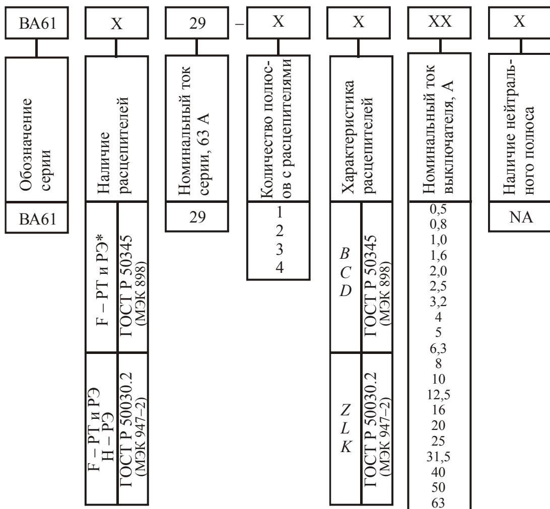
*Рис. 2.134. Структура условного обозначения выключателя ВА61-29:
