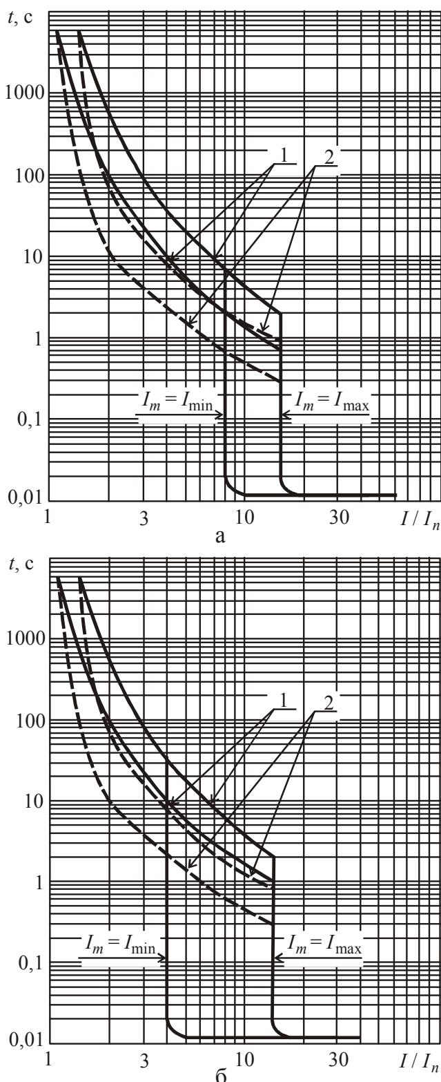
Рис. 2.130. Времятоковые характеристики выключателей серии ВА57-35 и ВА57Ф35 на токи 80 А (а) и 100 А (б): 1 – зона работы теплового максимального расцепителя тока, снятая с холодного состояния; 2 – зона работы теплового максимального расцепителя тока, снятая с нагретого состояния;  $I_m$  – уставка электромагнитного расцепителя тока КЗ
