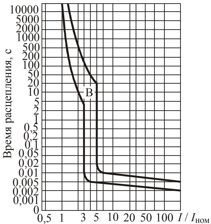
Рис. 2.166. Защитная характеристика автоматических выключателей BA-103 с В-типом электромагнитных расцепителей
