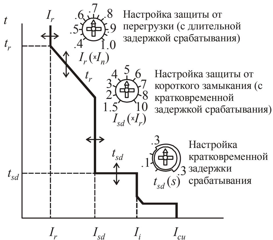
Рис. 2.63. Передняя панель электронного расцепителя серии ETS23 (а) и пример настройки защит от токов перегрузки и токов короткого замыкания (б)
