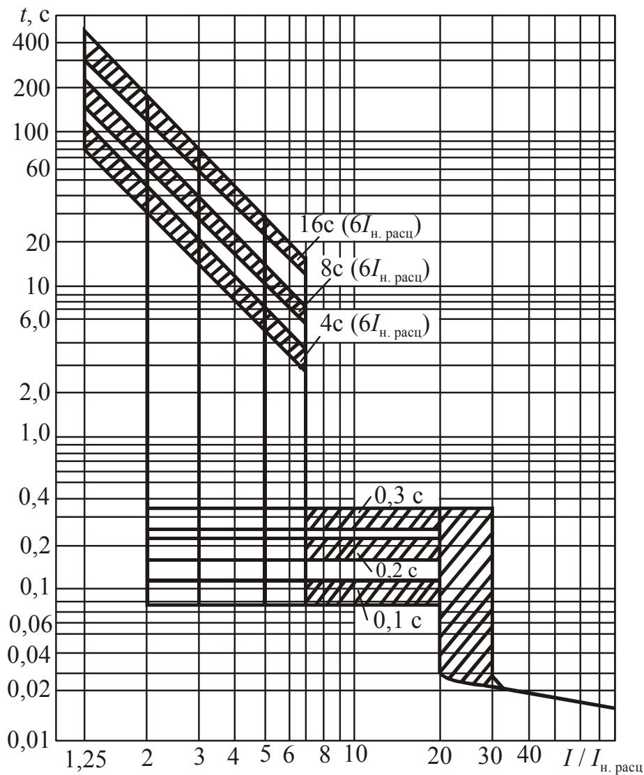
Рис. 2.50. Времятоковая характеристика автоматических выключателей BA55-41 с номинальным током полупроводникового расцепителя 1000 А
