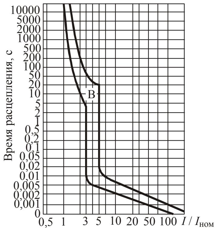
Рис. 2.163. Защитная характеристика автоматических выключателей BA-101, BA-102 и BA-201 с В-типовыми электромагнитными расцепителями
