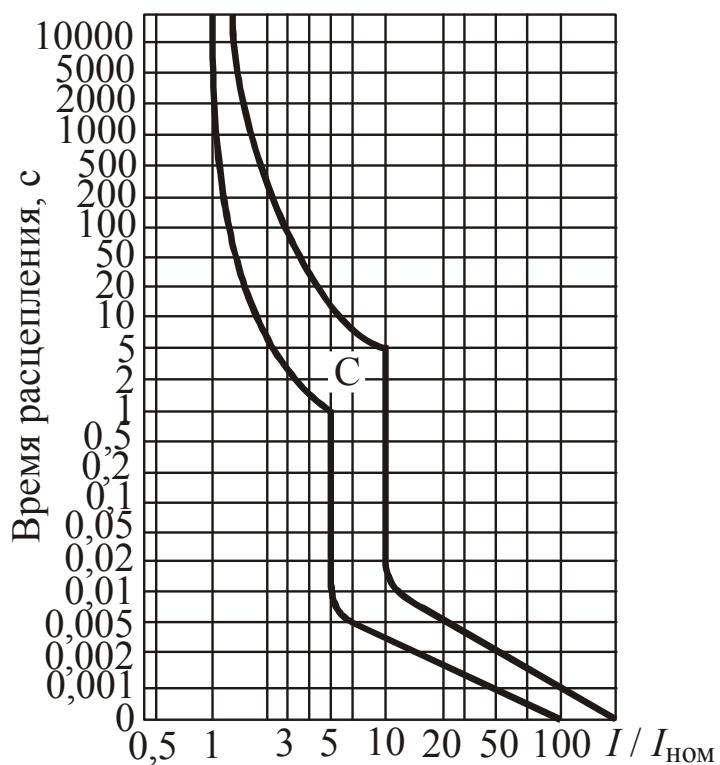
Рис. 2.164. Защитная характеристика автоматических выключателей BA-101, BA-102 и BA-201 с С-типовыми электромагнитными расцепителями
