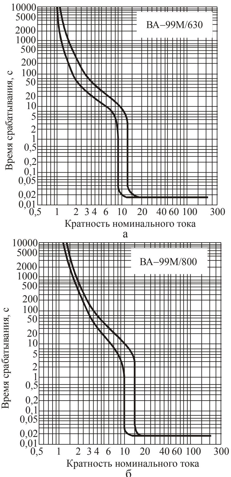
Рис. 2.154. Времятоковые характеристики отключения выключателей
