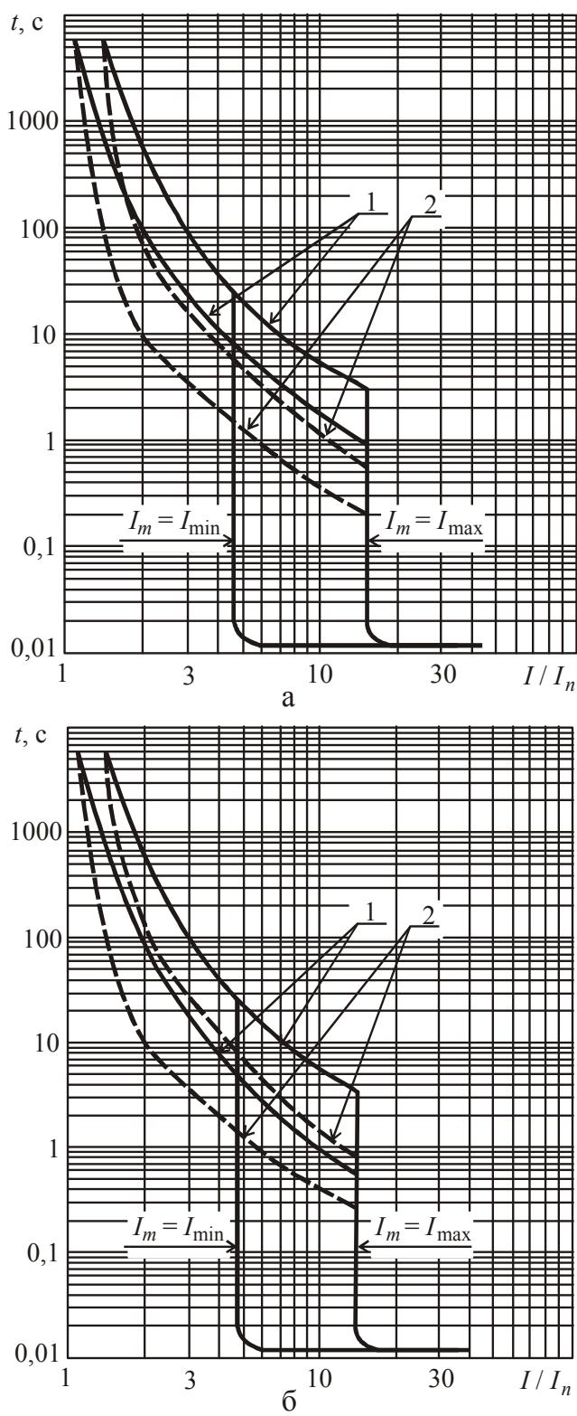
Рис. 2.131. Времяточевые характеристики выключателей серии ВА57-35 и ВА57Ф35 на токи 125 A (а) и 160, 200, 250 A (б): 1 – зона работы теплового максимального расцепителя тока, снятая с холодного состояния; 2 – зона работы теплового максимального расцепителя тока, снятая с нагреветого состояния;  $I_m$  – уставка электромагнитного расцепителя тока  $K3$
