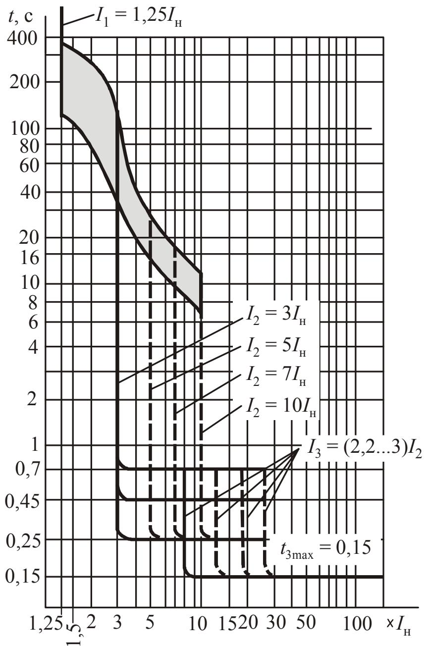
Рис. 3.11. Времятоковая характеристика выключателей с уставкой времени при  $6I_H$  равной 4 с и положении переключателей  $S1$  – в положении 7,  $S2$  – в положении 11
