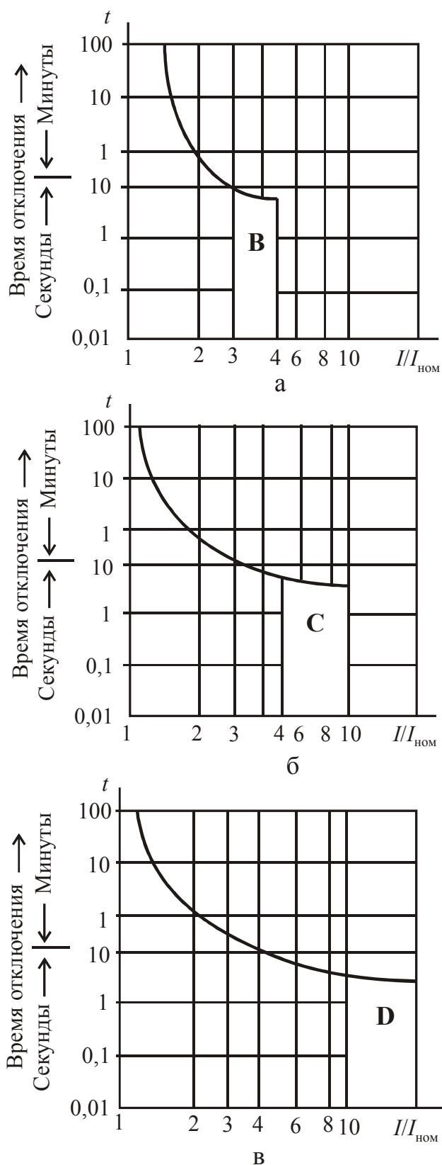
Рис. 1.7. Защитные характеристики автоматических выключателей:
