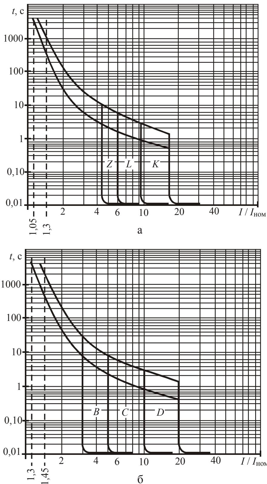
Рис. 2.135. Времяточевые характеристики BA61F29 при температуре  $+40^{\circ}\text{C}$ , характеристики  $Z$ ,  $L$ ,  $K$  (а), и при температуре  $+30^{\circ}\text{C}$ , характеристики  $B$ ,  $C$ ,  $D$  (б)
