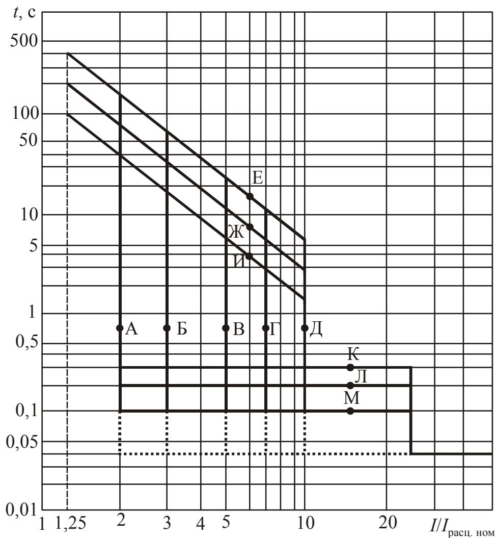
Рис. 2.44. Защитные характеристики выключателей переменного тока серий BA53, BA54, BA55, BA75 с полупроводниковым расцепителем.
