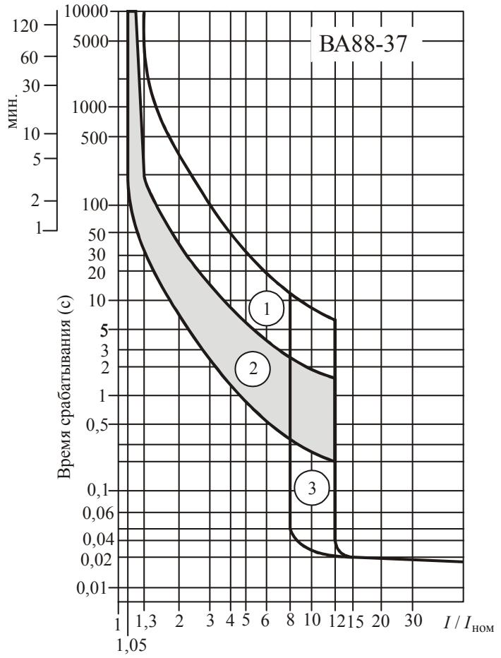
*Рис. 2.143. Времятоковая характеристика автоматического выключателя BA88-37: 1 – из холодного состояния; 2 – из нагретого состояния; 3 – зона срабатывания электромагнитного расцепителя*
