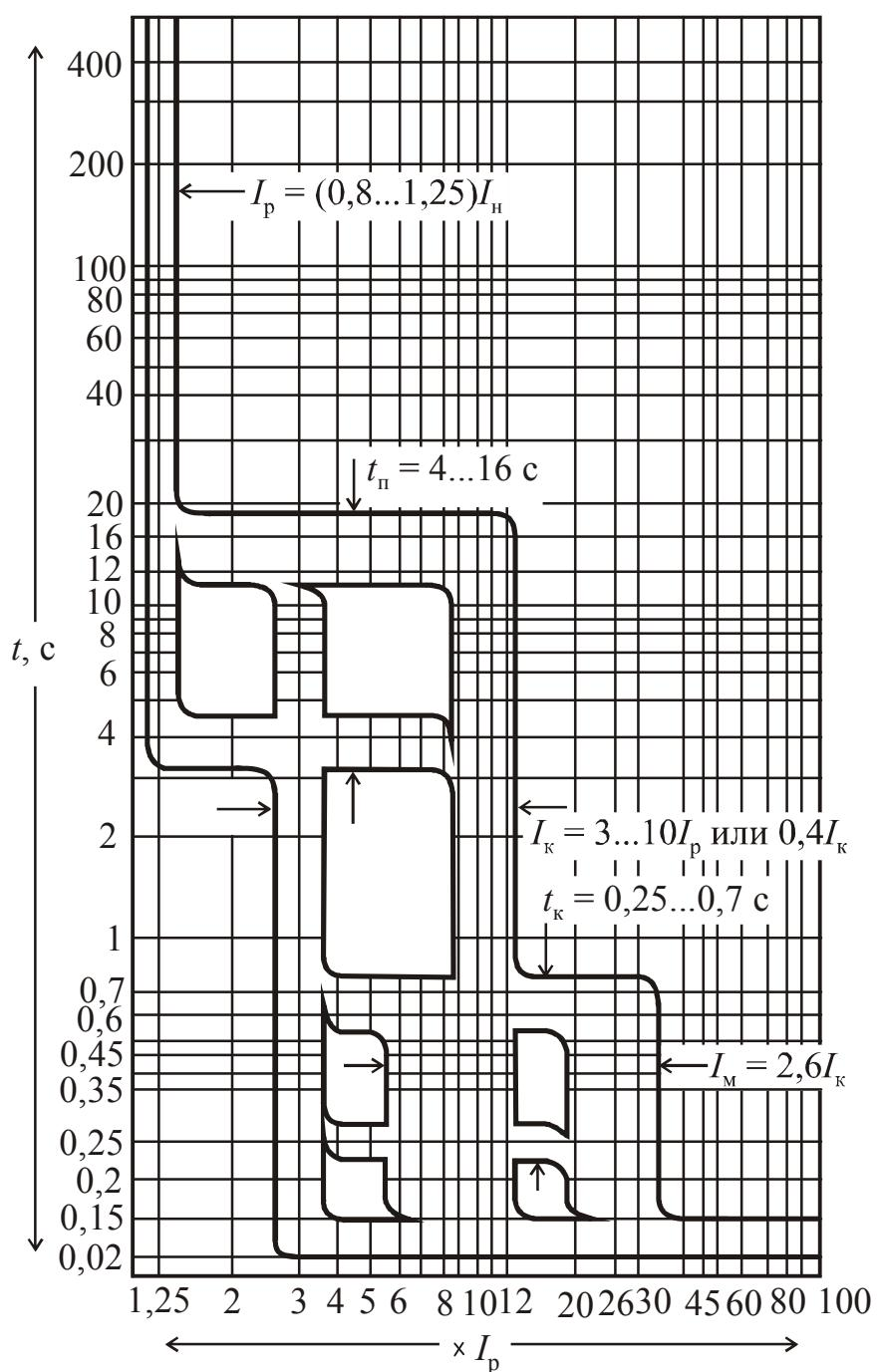
Рис. 3.3. Времятоковая характеристика выключателей переменного тока серии «Электрон» с независимой от величины тока выдержкой времени в зоне токов перегрузки
