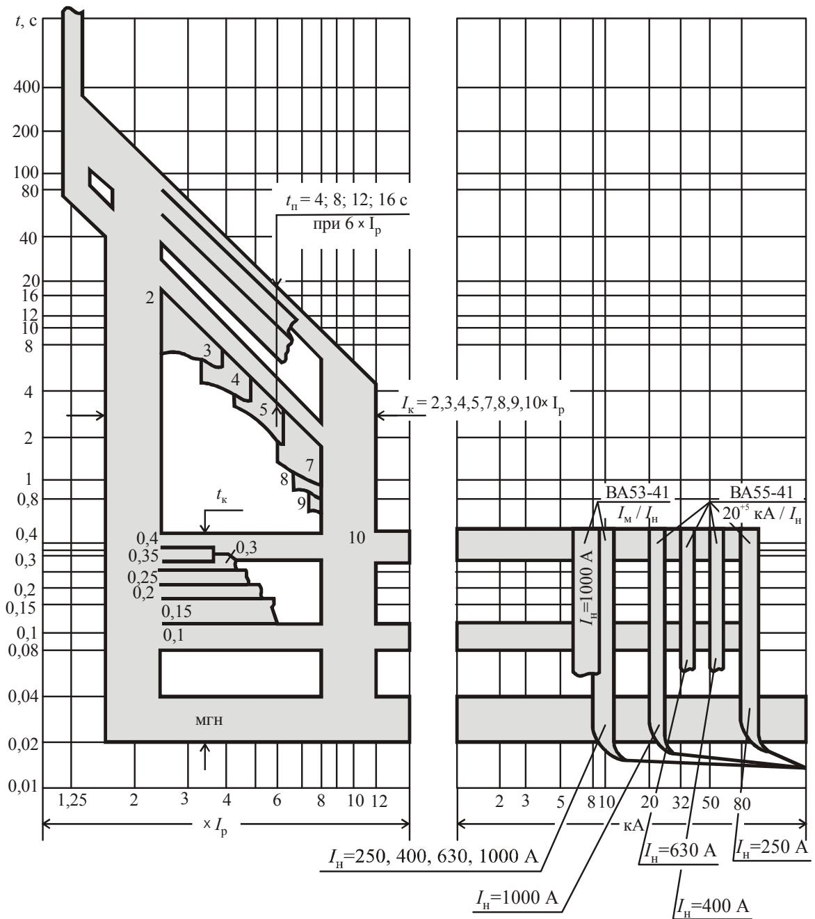
Рис. 2.31. Время-токовая характеристика выключателей переменного тока BA53-41 и BA55-41 с блоками MPT1, MPT2, пределы отклонений уставок см. таблицы 2.13, 2.14
