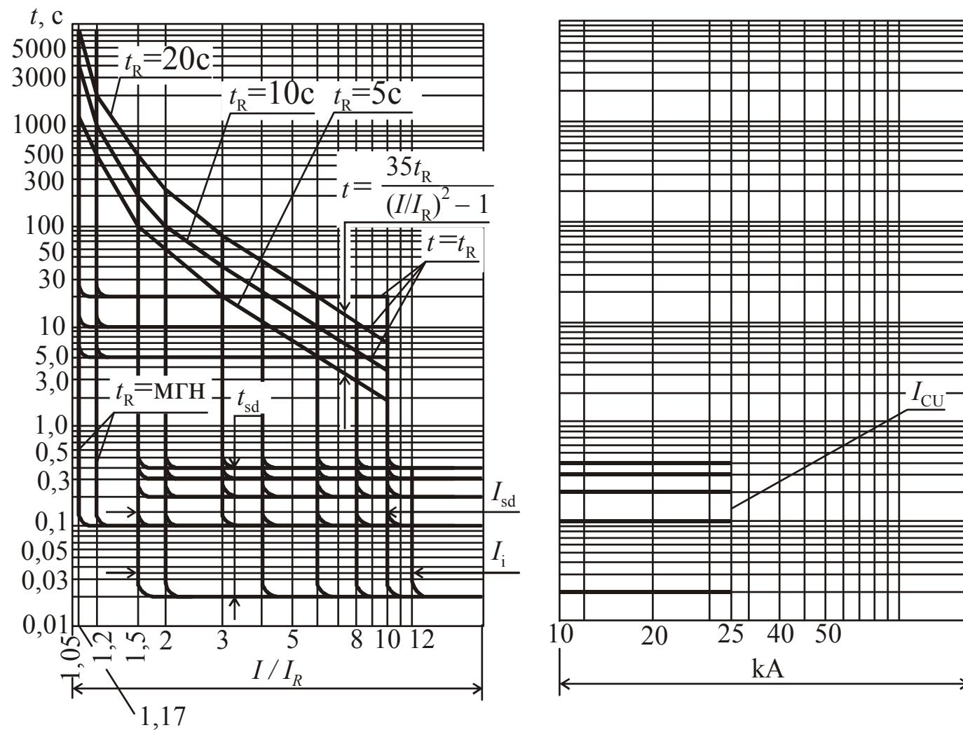
Рис. 2.10. Времятоковая характеристика выключателя переменного тока BA08-0405C, BA08-0635C, BA08-0805C с электронным (микропроцессорным) расцепителем тока
