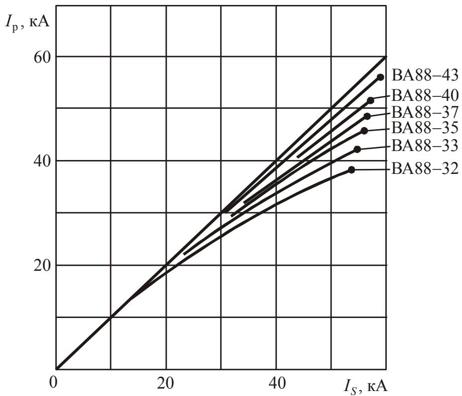
Рис. 2.192. Характеристики токоограничения выключателей ВА88 при напряжение 400 В:  $I_p$  – фактический ток при отключении (мгновенное значение);  $I_S$  – ожидаемый ток короткого замыкания (действующее значение)
