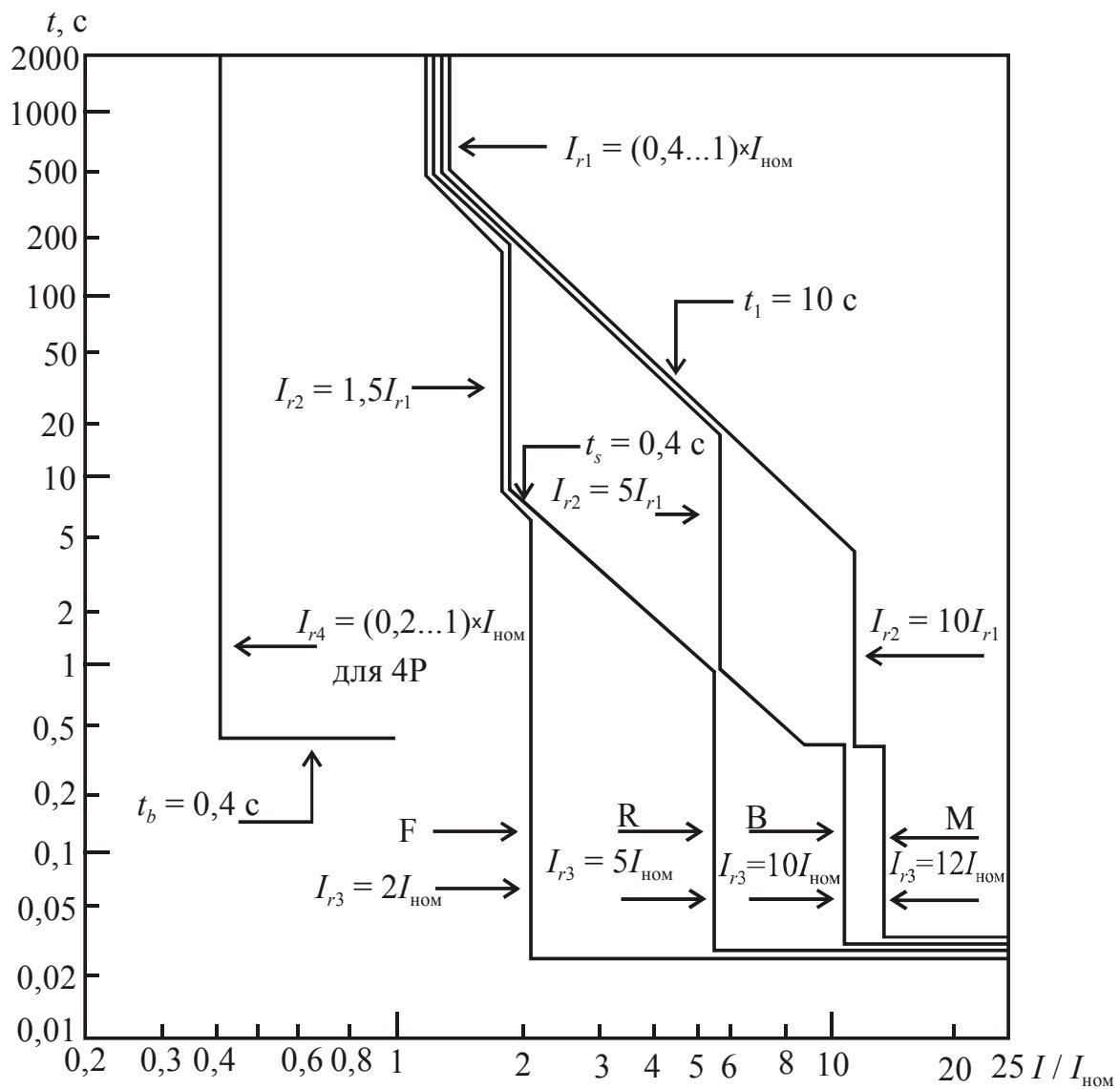
Рис. 2.55. Времятоковая характеристики автомата BA88-43 с электронным (микропроцессорным) расцепителем при включении по  $I^2 \cdot t$
