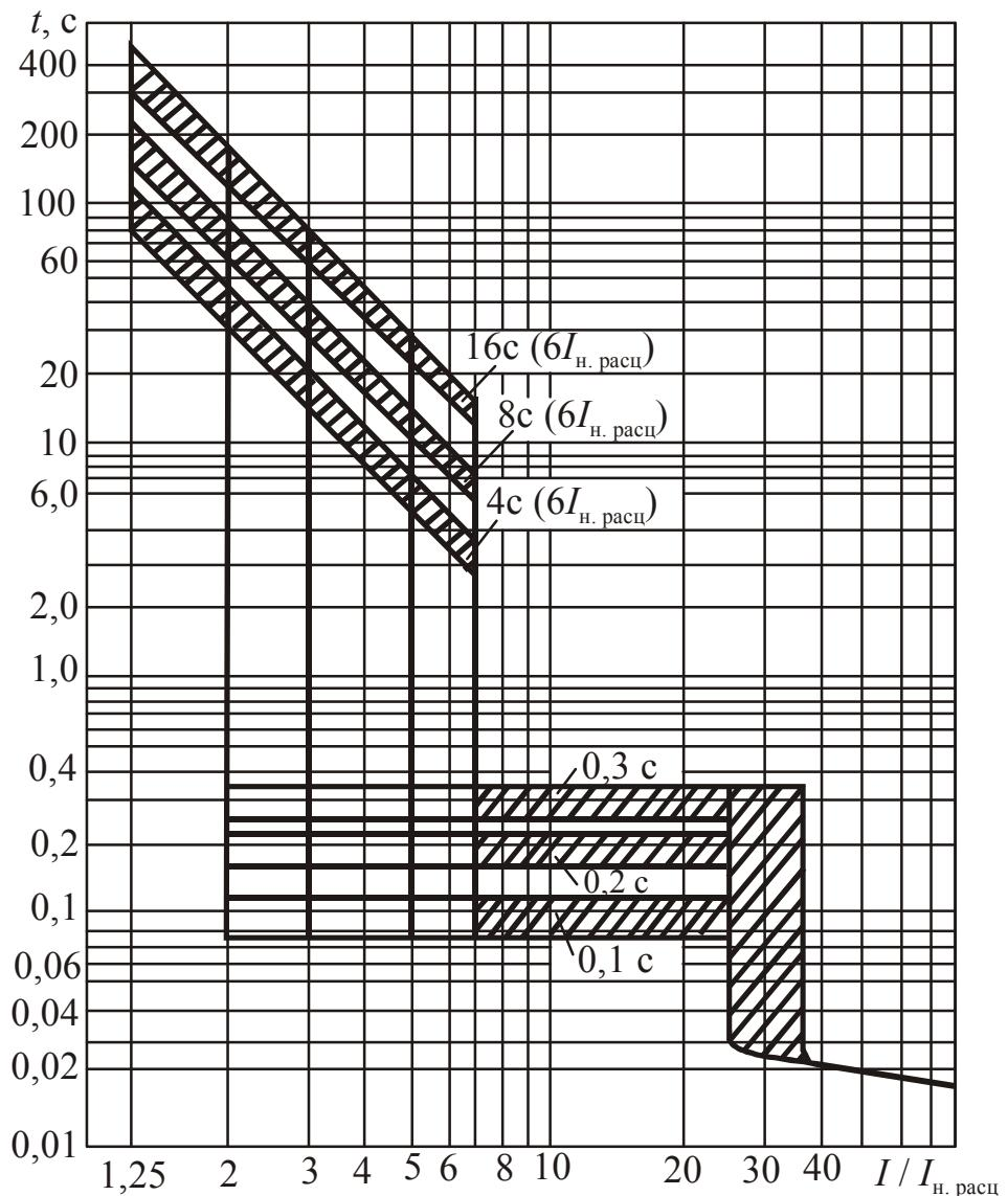
Рис. 2.49. Времятоковая характеристика автоматических выключателей BA55-41 с номинальным током полупроводникового расцепителя 800 А
