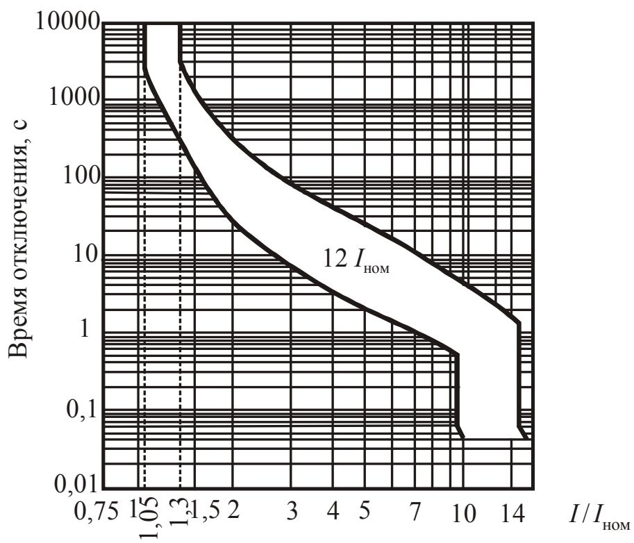
Рис. 9.4. Времяточковые характеристики выключателей серии AE2040М
