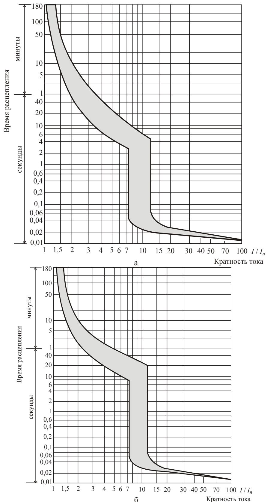
Рис. 2.150. Времятоковые характеристики отключения выключателей
