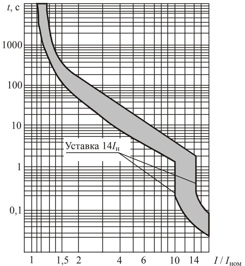
Рис. 2.106. Времяточковые характеристики отключения выключателя BA51Г25
