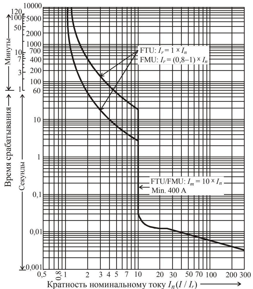
Рис. 2.171. Времятоковые характеристики автоматических выключателей TD100 с расцепителями FTU, FMU на токи 100–160 А
