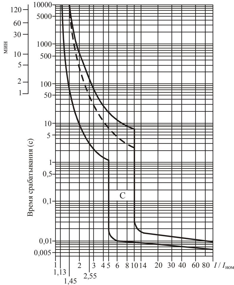
Рис. 2.102. Времятоковые характеристики отключения выключателей BA47-29M при температуре окружающей среды +30 °C. Пунктирная линия – верхняя граница времятоковой характеристики для автоматических выключателей с номинальным током  $I_{\text{ном}} \leq 32 \text{ A}$
