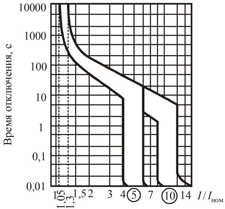
Рис. 9.5. Времяточковые характеристики выключателей AE2066M1 при температуре  $30\pm2^\circ\text{C}$  (влияние температуры окружающей среды приведено на рис. 9.6)
