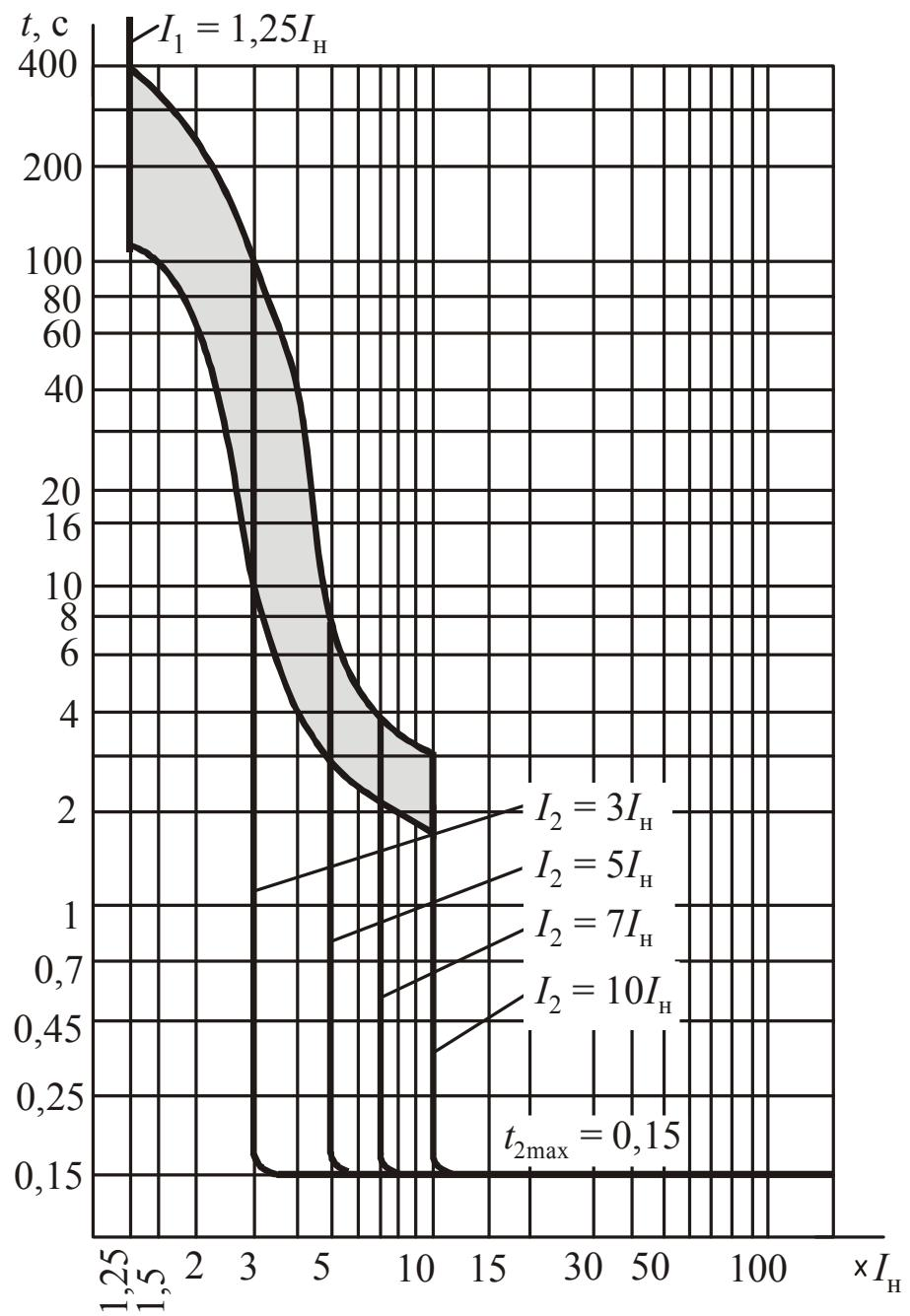
Рис. 3.9. Времятоковая характеристика выключателей с уставкой времени при  $6I_H$  равной 8 с и положении переключателей  $S1$  – в положении 6,  $S2$  – в положении 11
