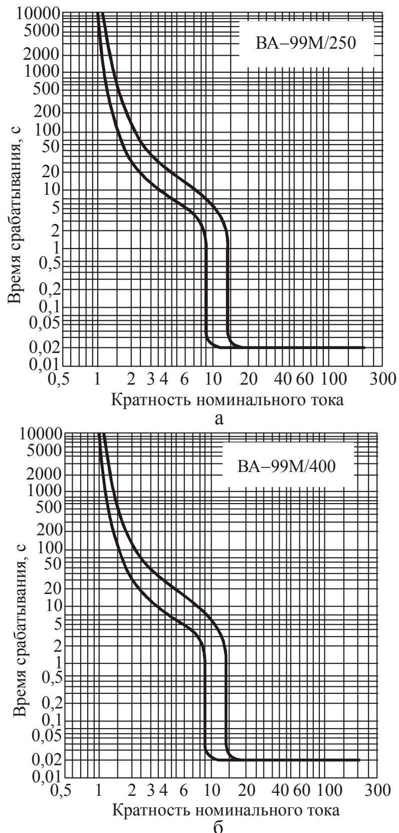
Рис. 2.153. Времяточковые характеристики отключения выключателей
