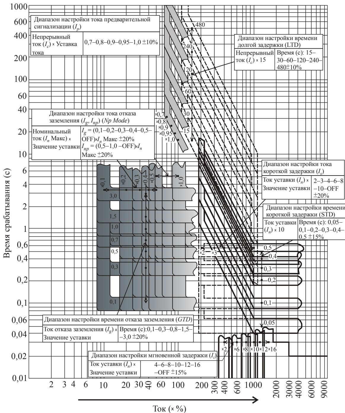
Рис. 2.73. Характеристика блока OCR-II LGP, LTH, LN6, LN5
