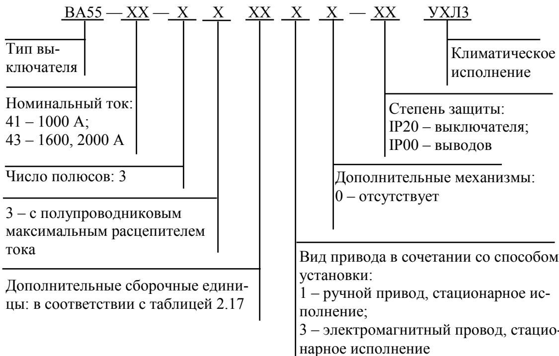
Рис. 2.39. Структура условного обозначения выключателей серии BA55
