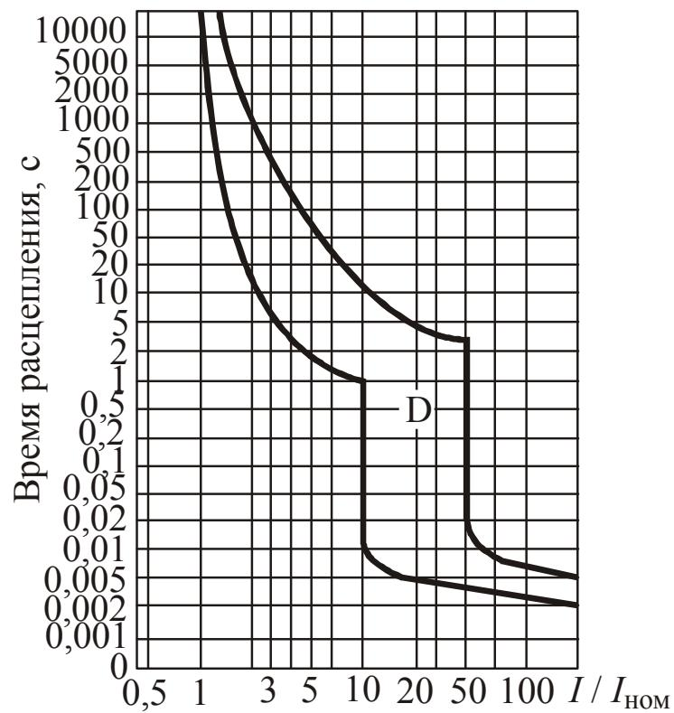
Рис. 2.168. Защитная характеристика автоматических выключателей BA-103 с D-типом электромагнитных расцепителей
