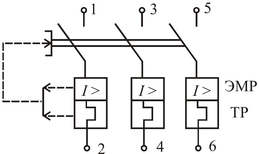
Рис. 2.2. Принципиальная электрическая схема выключателей серии ВА с электромагнитным (EMP) и тепловым (TP) расцепителем
