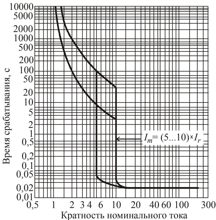
*Рис. 2.160. Времятоковые характеристики автоматических выключателей BA-99C/250*
