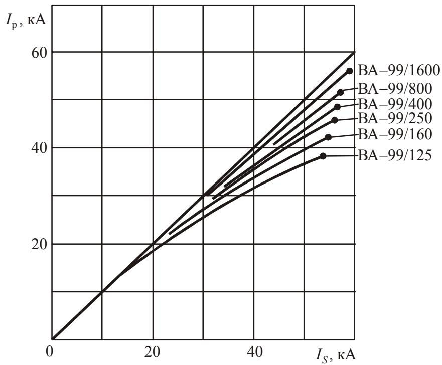
Рис. 2.193. Характеристики токоограничения автоматических выключателей BA-99 при напряжение 400 В:  $I_p$  – фактический ток при отключении (мгновенное значение);  $I_S$  – ожидаемый ток короткого замыкания (действующее значение)
