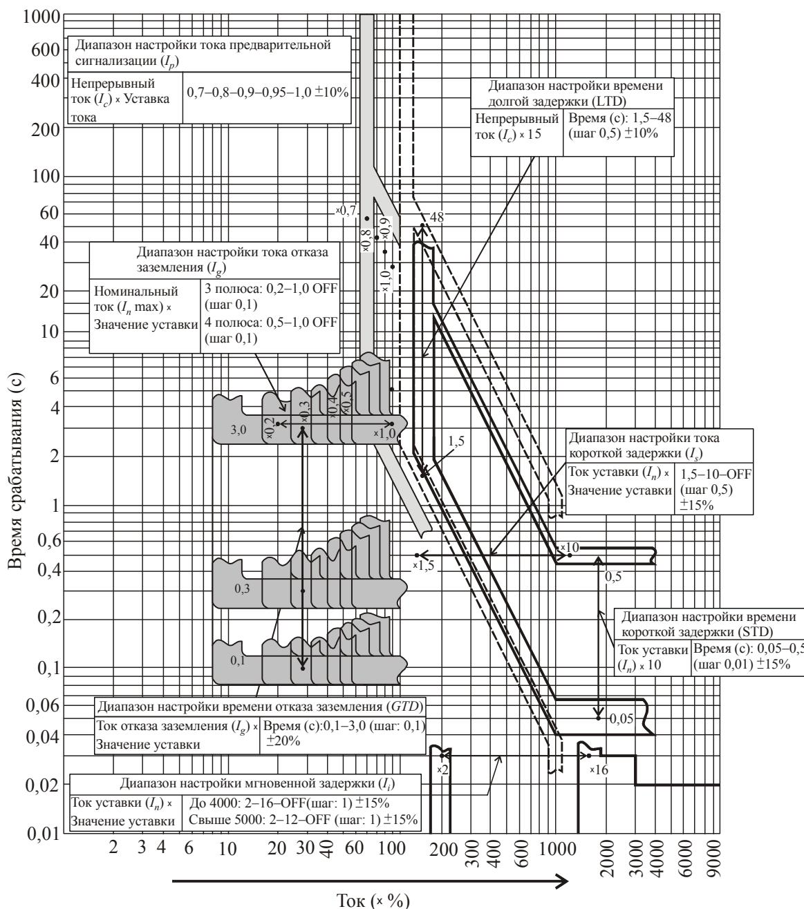
Рис. 2.75. Характеристика блока OCR-III P6, M6, P5, M5
