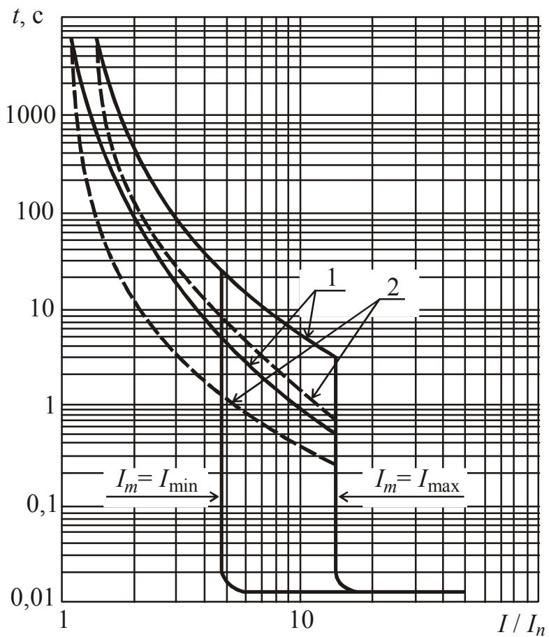
Рис. 2.111. Времяточевые характеристики выключателей ВА51-35 на токи 160, 200, 250 А: 1 – зона работы теплового максимального расцепителя тока, снятая с холодного состояния; 2 – зона работы теплового максимального расцепителя тока, снятая с нагреветого состояния;  $I_m$  – уставка электромагнитного расцепителя тока короткого замыкания
