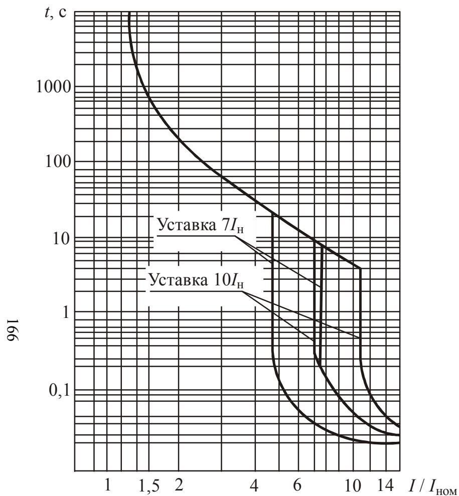
Рис. 2.105. Времяточковые характеристики отключения выключателя BA51-25
