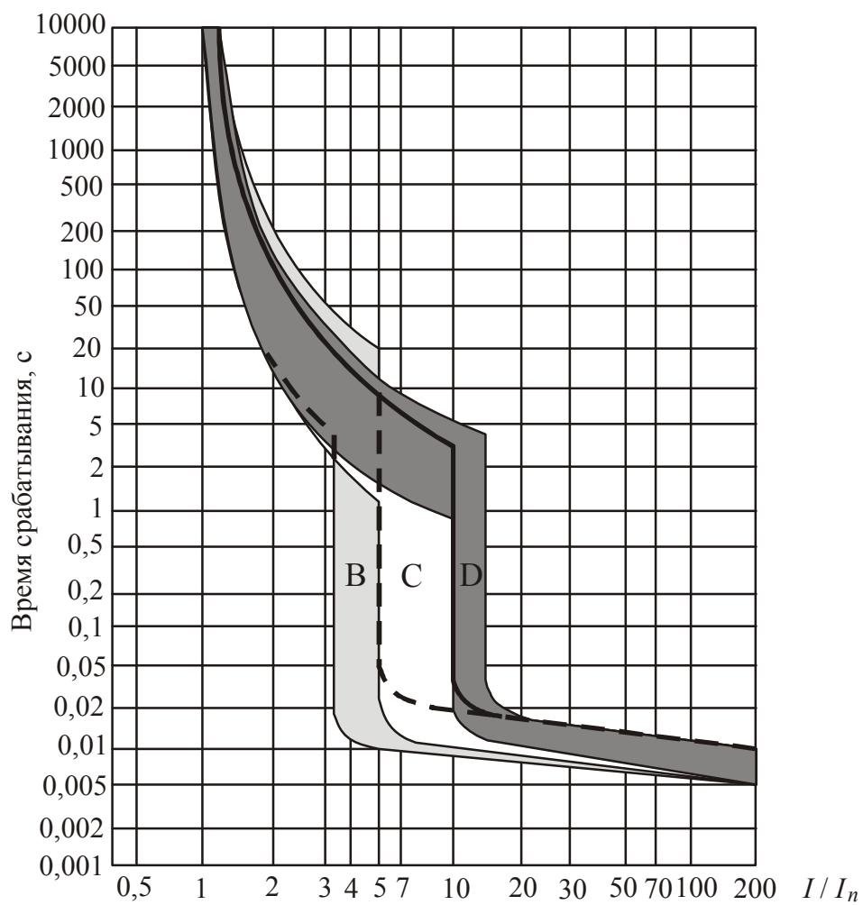
Рис. 2.104. Стандартные времятоковые характеристики отключения выключателя ВА47-63 при температуре окружающей среды  $+30^{\circ}\text{C}$ : В – срабатывание электромагнитной защиты между 3 – и 5 – кратным значением номинального тока; С – срабатывание электромагнитной защиты между 5 – и 10 – кратным значением номинального тока; Д – срабатывание электромагнитной защиты между 10 – и 50 – кратным значением номинального тока.
