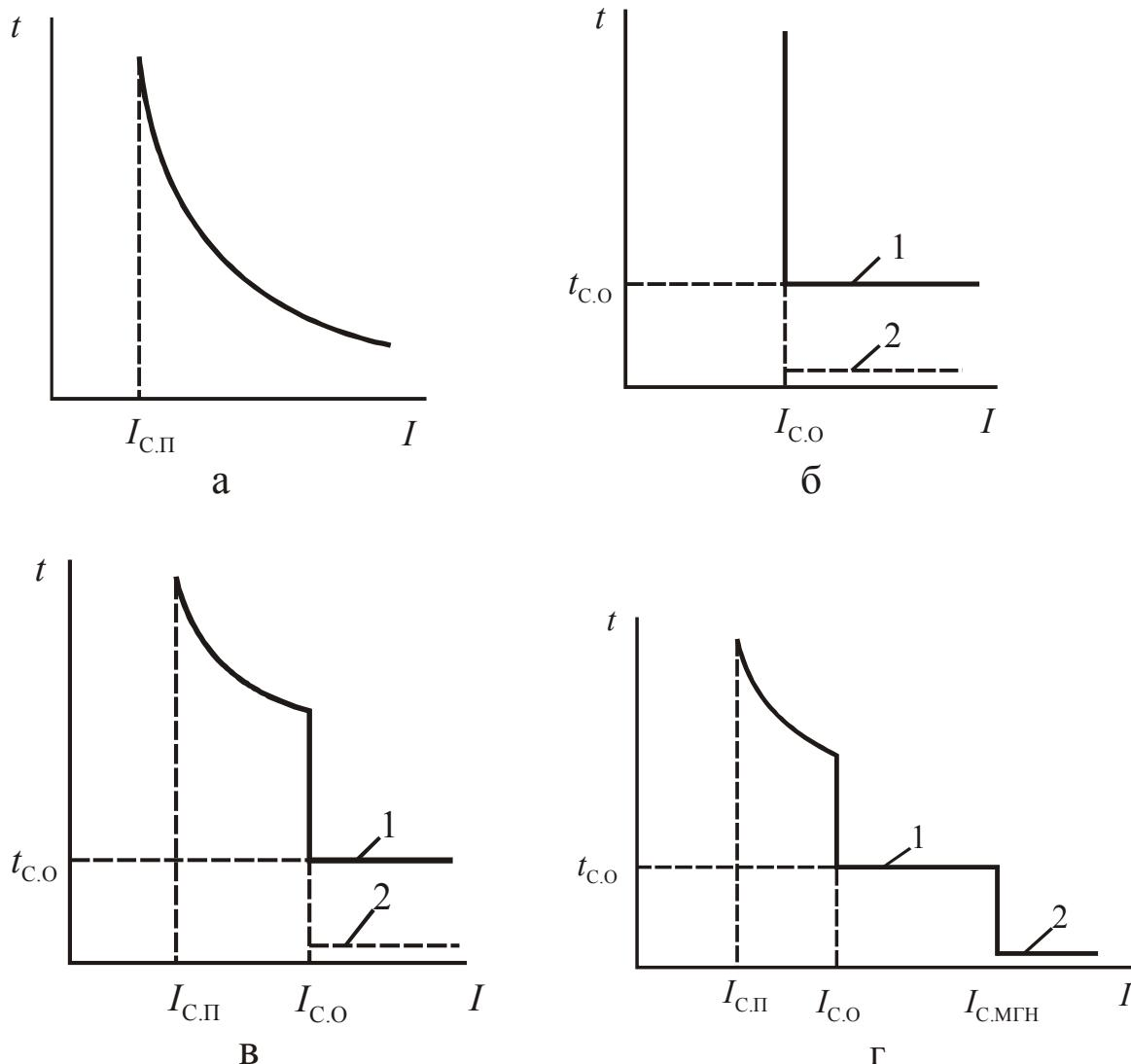
*Рис. 1.6. Защитные характеристики автоматических выключателей:
