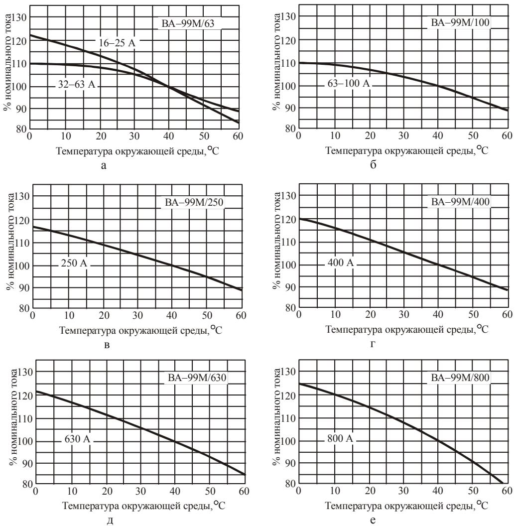
Рис. 2.155. Влияние температуры окружающей среды на номинальный ток тепловых расцепителей выключателей: а – BA-99M/63; б – BA-99M/100; в – BA-99M/250; г – BA-99M/400; д – BA-99M/630; е – BA-99M/800
