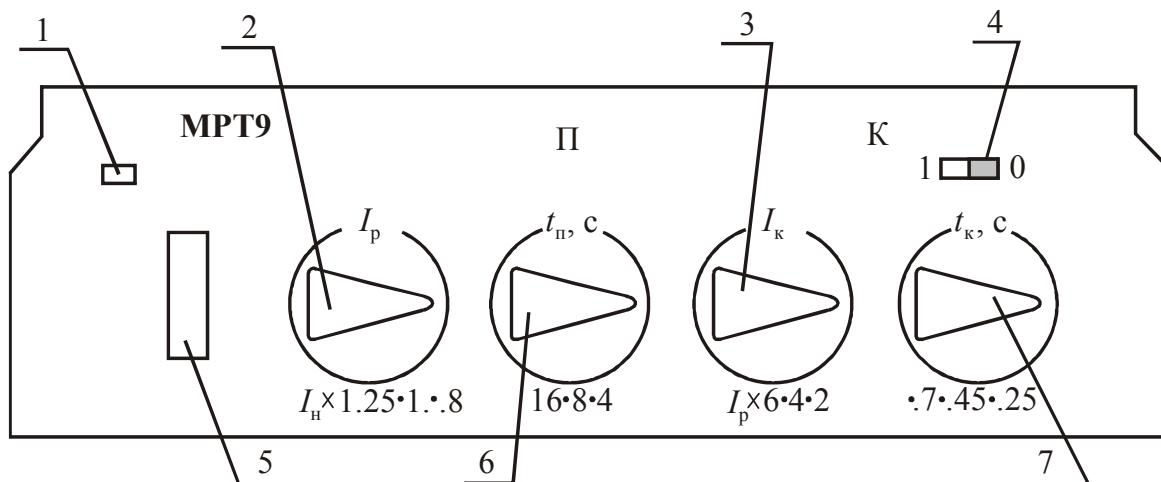
Рис. 3.5. Лицевая панель блока МРТ9 выключателей «Электрон» постоянного тока: 1 – индикатор наличия электропитания; 2 – ручка уставок номинального тока  $I_p$ ; 3 – ручка уставок токов короткого замыкания; 4 – включение режима мгновенного срабатывания при коротком замыкании (выступающая часть перемычки переключателя влево – включен, вправо – выключен); 5 – разъем «TEST»; 6 – ручка уставок врем-
