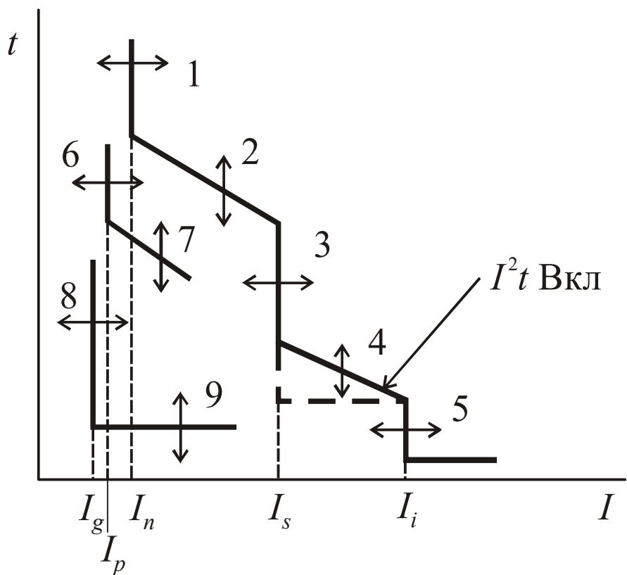
Рис. 2.71. Схема защитных характеристик электронных расцепителей выключателей ВА-СЭЩ-LBA:
