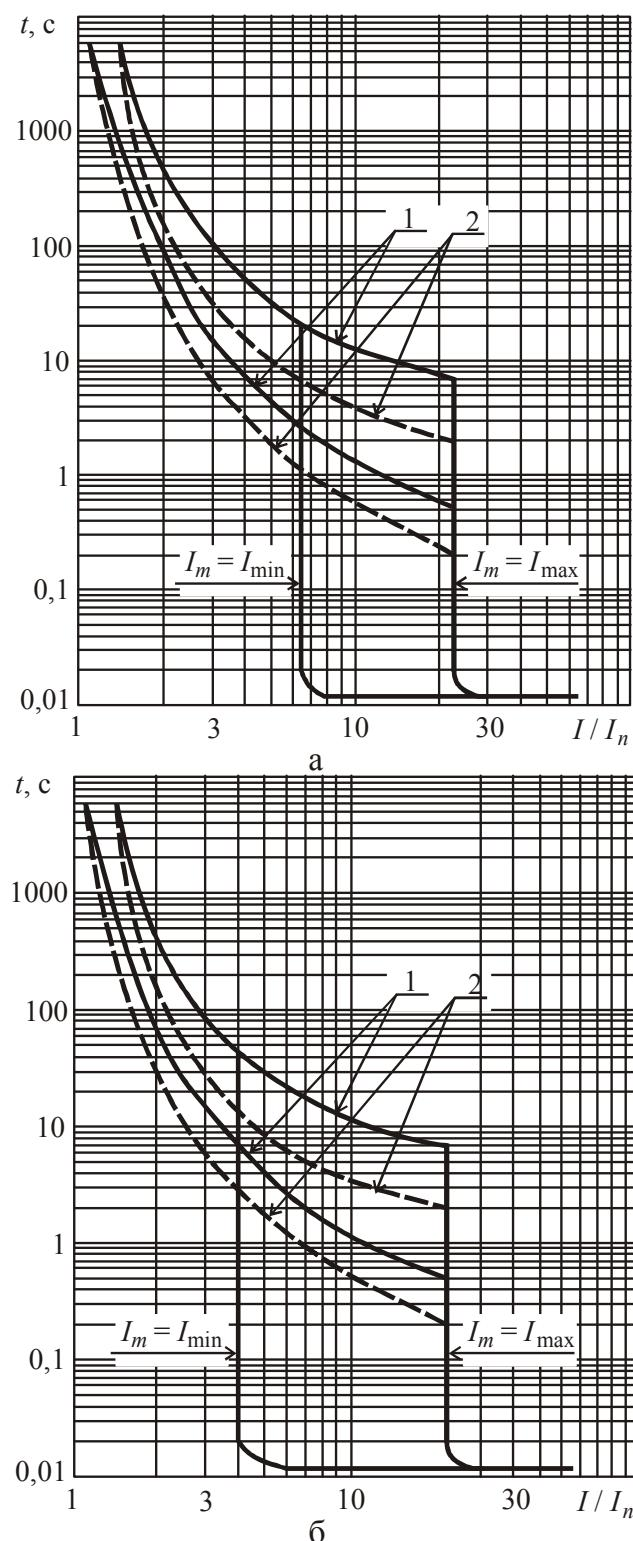
Рис. 2.127. Времяточевые характеристики выключателей серии ВА57-31 на токи 50; 63 А (а) и на токи 80; 100 А (б): 1 – зона работы теплового максимального расцепителя тока, снятая с холодного состояния; 2 – зона работы теплового максимального расцепителя тока, снятая с нагретого состояния;  $I_m$  – уставка электромагнитного расцепителя тока КЗ
