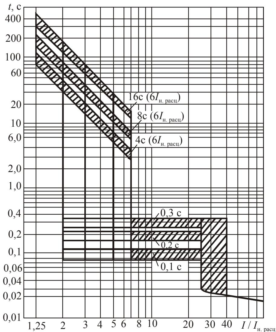
Рис. 2.53. Времяточковые характеристики отключения автоматического выключателя ВА85-41
