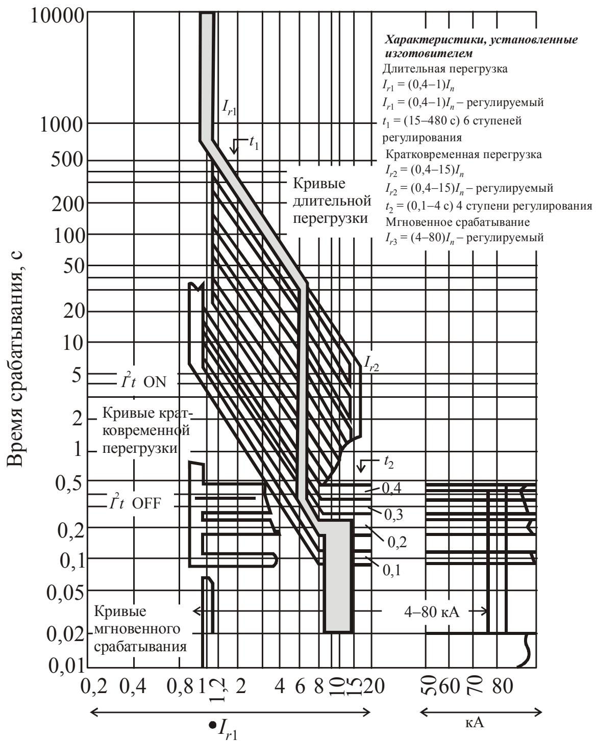
Рис. 2.21. Времяточевые характеристики автоматических выключателей BA-45/4000 с микропроцессором типа М, Н
