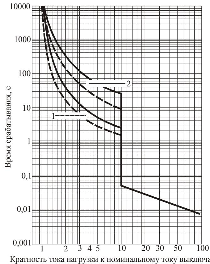
*Рис. 2.77. Времятиковые характеристики отключения выключателей BA04 35 Про ( $C-P-B$ ,  $I_{ном} = 125-250\text{ A}$ ) при температуре окружающей среды  $40^{\circ}\text{C}$ : 1 – зона работы от «горячего» состояния теплового расцепителя; 2 – зона работы от «холодного» состояния теплового расцепителя*
