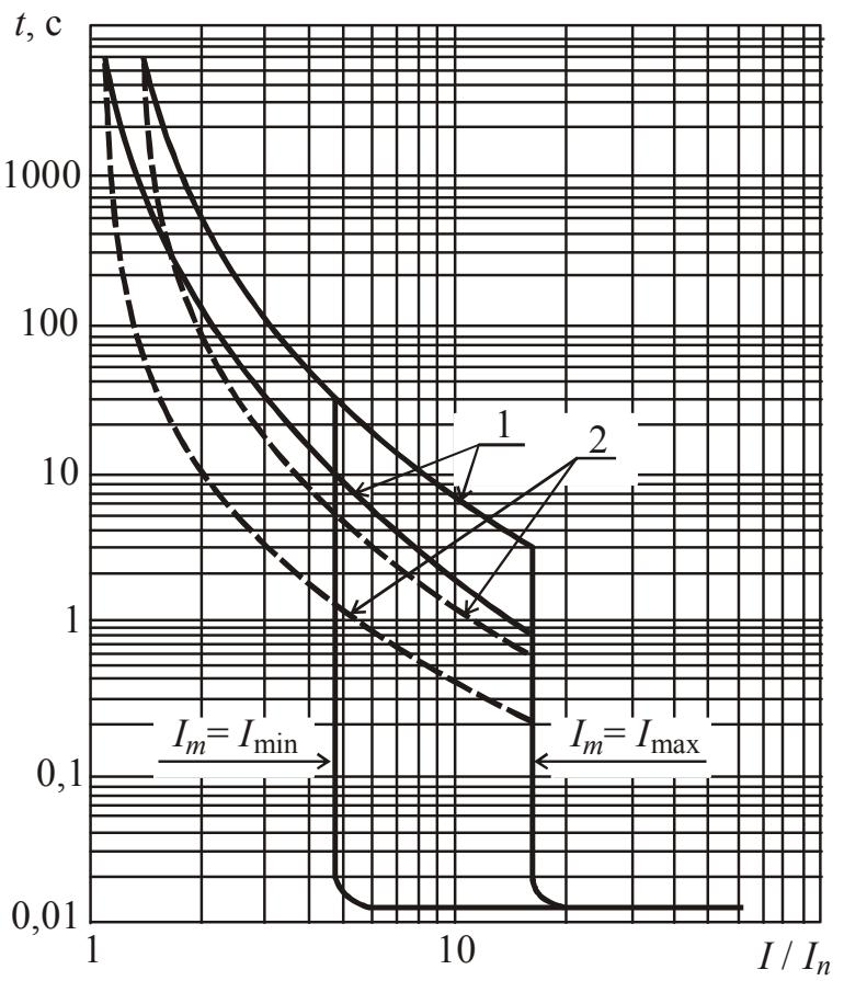
Рис. 2.110. Времятоковые характеристики выключателя BA51-35 на ток 125 А: 1 – зона работы теплового максимального расцепителя тока, снятая с холодного состояния; 2 – зона работы теплового максимального расцепителя тока, снятая с нагреветого состояния;  $I_m$  – уставка электромагнитного расцепителя тока КЗ
