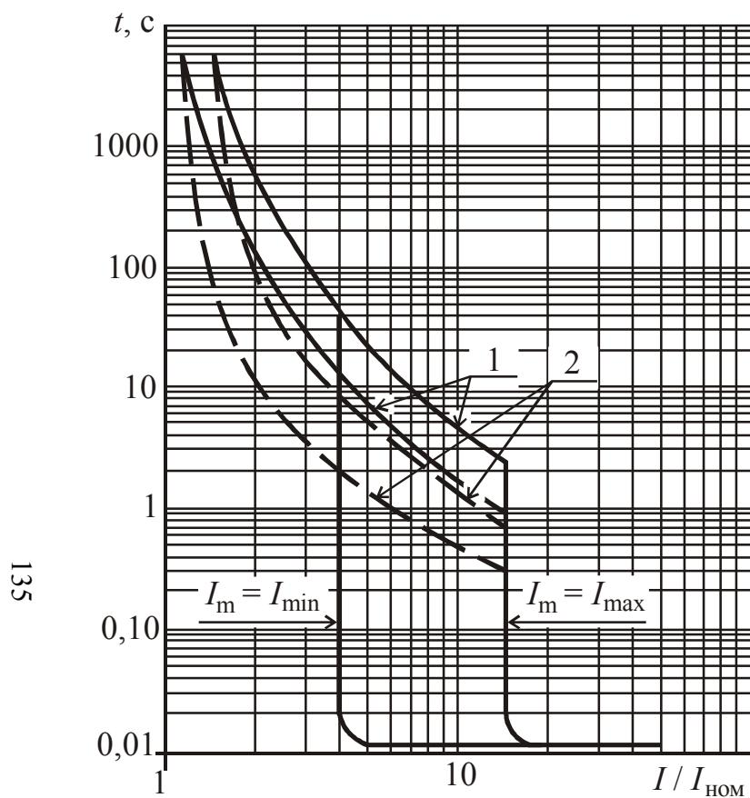
Рис. 2.80. Времятоковые характеристики выключателей BA04–36 на ток 100 А: 1 – зона работы теплового максимального расцепителя тока, снятая с холодного состояния; 2 – зона работы теплового максимального расцепителя тока, снятая с нагретого состояния;  $I_m$  – уставка электромагнитного расцепителя тока короткого замыкания
