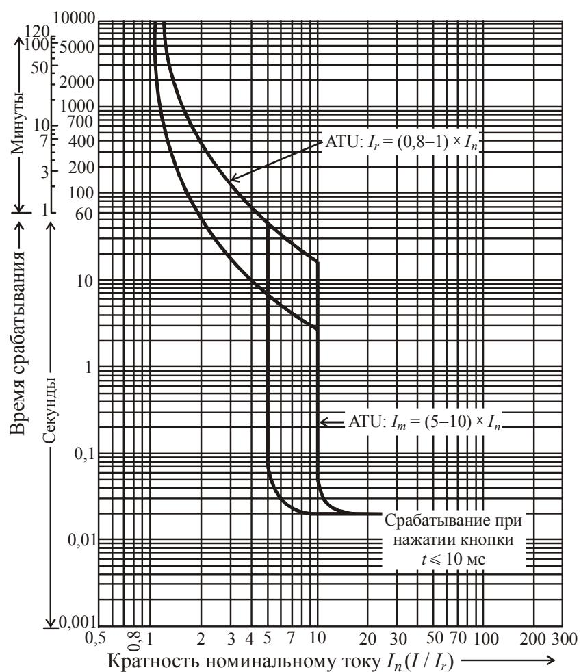
Рис. 2.175. Времятковые характеристики автоматических выключателей TS160 с расцепителями ATU на токи 100–160 А
