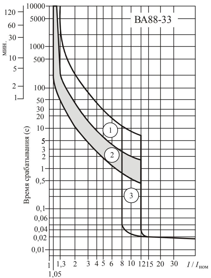
*Рис. 2.141. Времятоковая характеристика автоматического выключателя BA88-33: 1 – из холодного состояния; 2 – из нагреветого состояния; 3 – зона срабатывания электромагнитного расцепителя*
