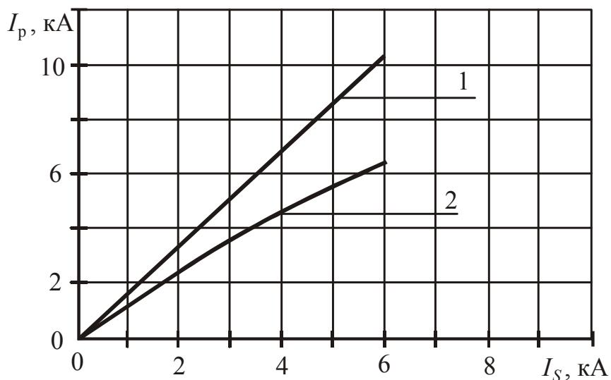
Рис. 2.191. Характеристики токоограничения выключателей ВА61-29:
