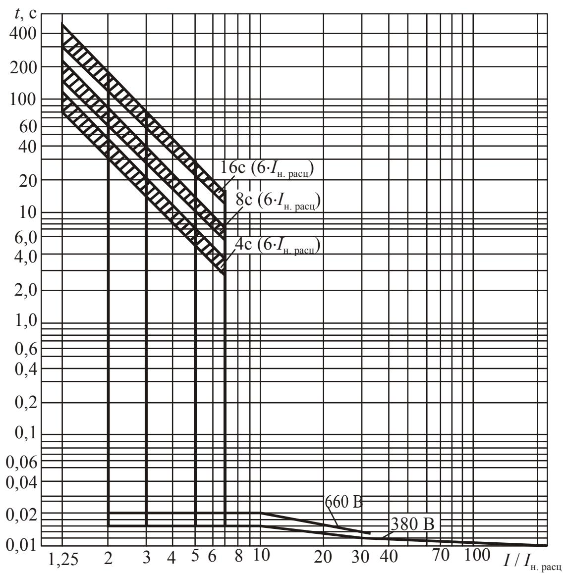
Рис. 2.52. Времяточковые характеристики отключения автоматического выключателя ВА83-41
