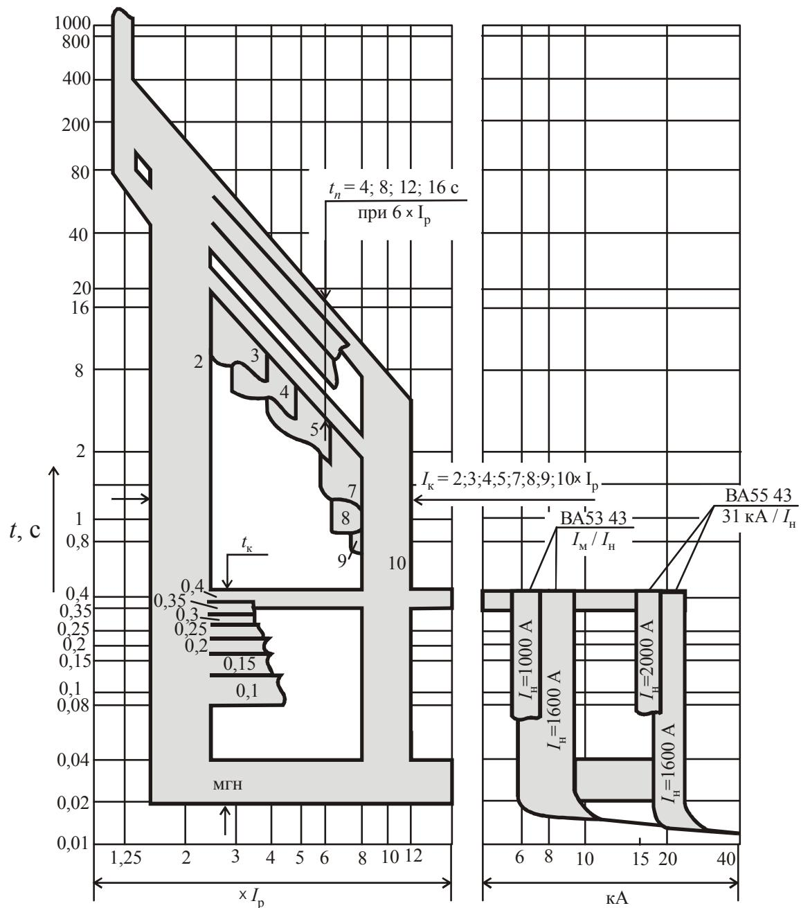
Рис. 2.34. Времятоковая характеристика выключателей переменного тока BA53 43 и BA55 43 с блоками MPT1, MPT2, пределы отклонений уставок см. таблицы 2.13, 2.14
