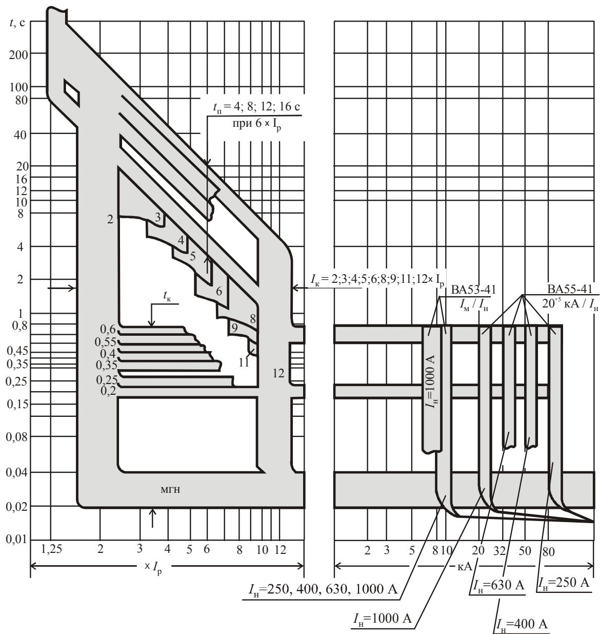
Рис. 2.32. Времятоковая характеристика выключателей переменного тока BA53-41 и BA55-41 с блоком МРТ4, пределы отклонений уставок см. таблицы 2.13, 2.15
