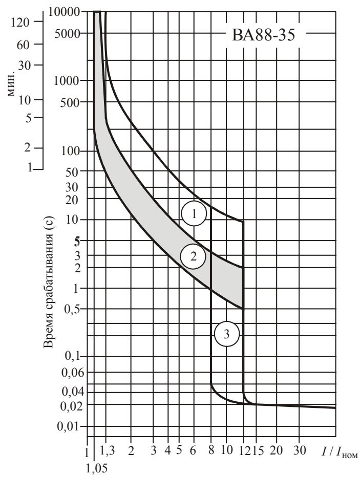
*Рис. 2.142. Времятоковая характеристика автоматического выключателя BA88-35: 1 – из холодного состояния; 2 – из нагретого состояния; 3 – зона срабатывания электромагнитного расцепителя*
