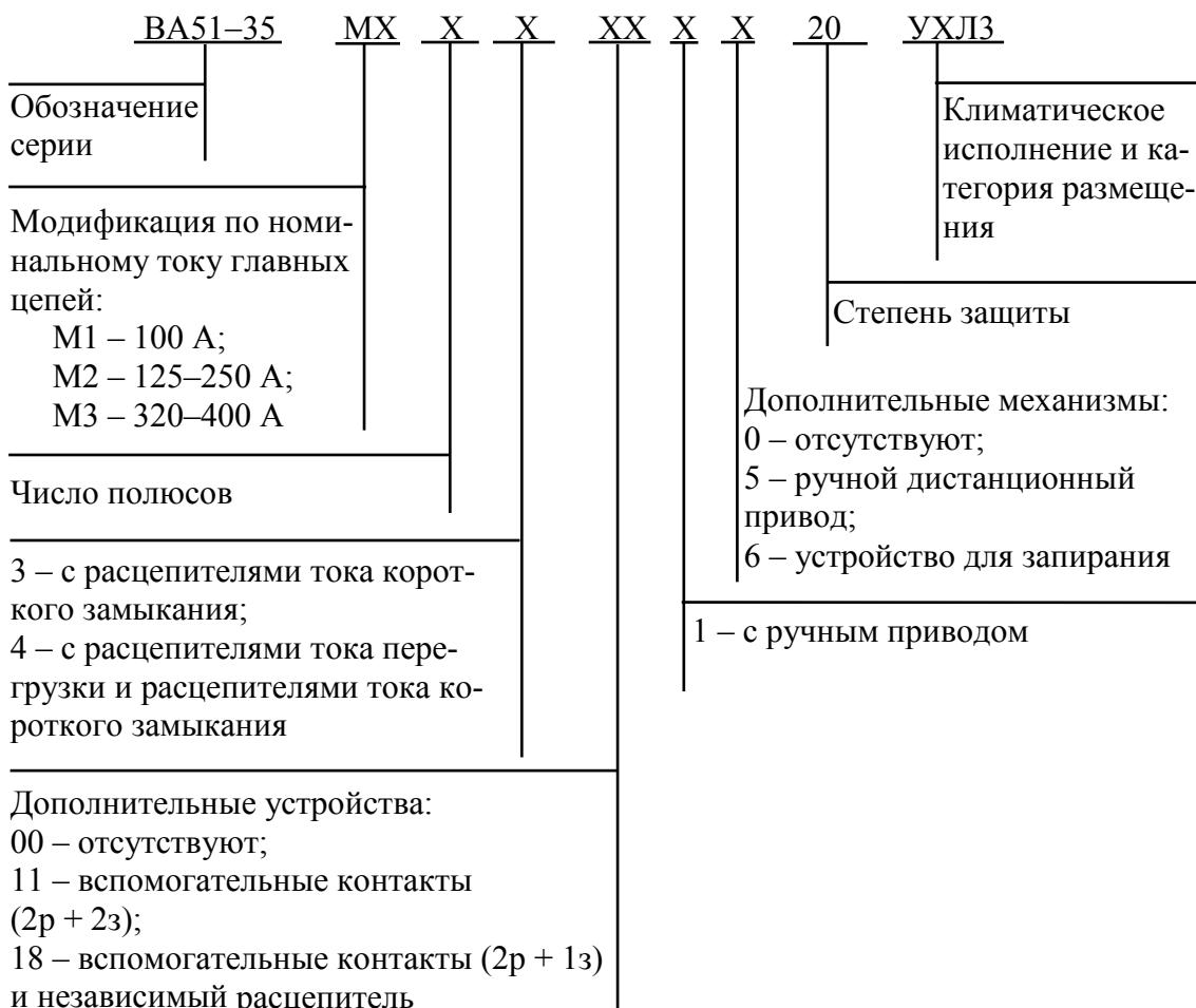
Рис. 2.108. Структура условного обозначения выключателей серии BA51-35
