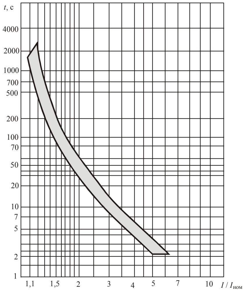
Рис. 2.94. Времятоковые характеристики отключения теплового расцепителя выключателя BA16
