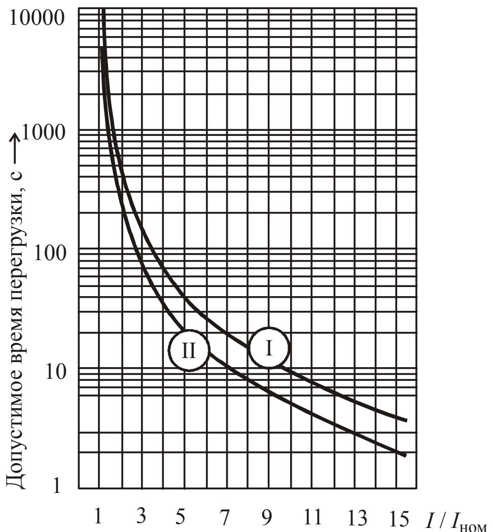
Рис. 2.91. Допустимые перегрузки выключателей ВА13 с электромагнитными расцепителями: I –  $20^{\circ}\text{C}$  в холодном состоянии; II –  $40^{\circ}\text{C}$  в нагретом состоянии
