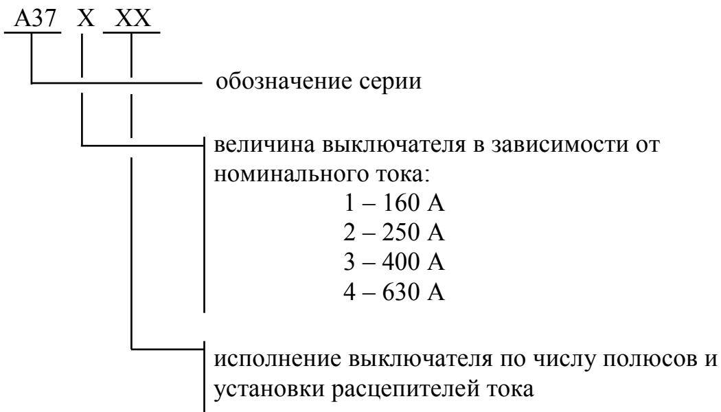
*Рис. 5.5. Структура условного обозначения автоматического выключателя серии A3700*
