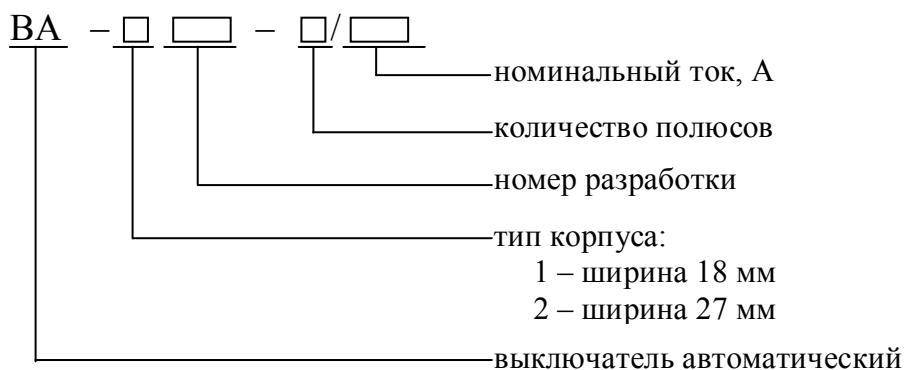
Рис. 2.162. Структура условного обозначения автоматических выключателей BA-101, BA-102, BA-103, BA-201
