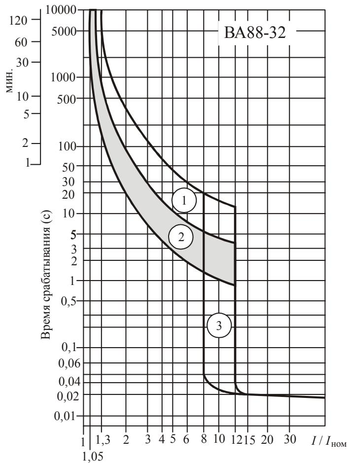
*Рис. 2.140. Времятоковая характеристика автоматического выключателя BA88-32: 1 – из холодного состояния; 2 – из нагреветого состояния; 3 – зона срабатывания электромагнитного расцепителя*
