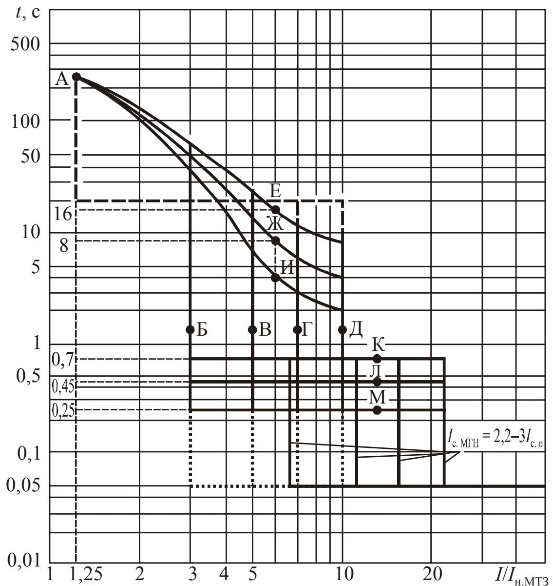
*Рис. 3.7. Защитные характеристики выключателя «Электрон» с полупроводниковым реле серии РМТ
