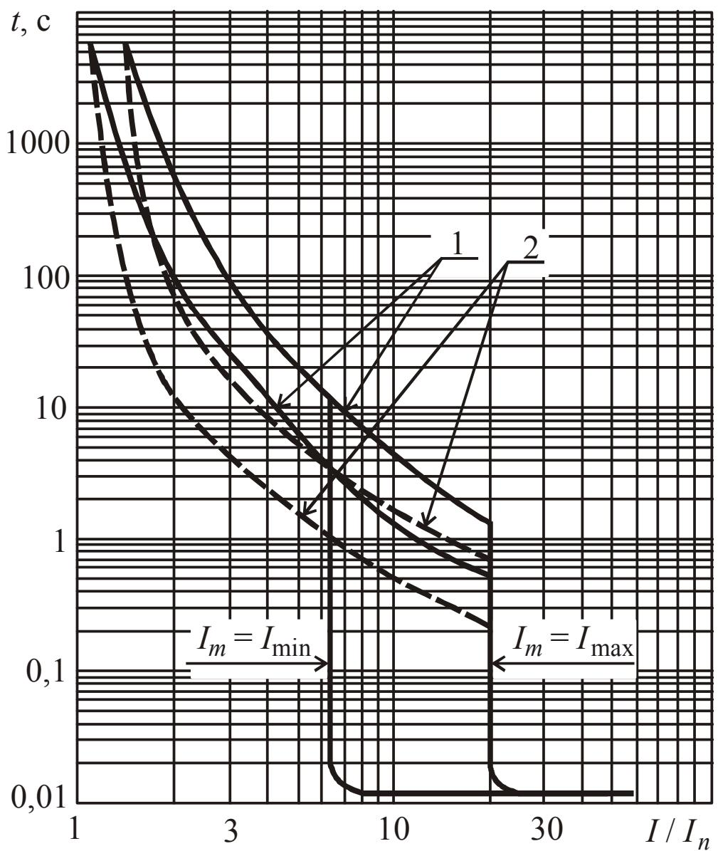
Рис. 2.129. Времятоковые характеристики выключателей серии ВА57-35 и ВА57Ф35 на ток 63 А: 1 – зона работы теплового максимального расцепителя тока, снятая с холодного состояния; 2 – зона работы теплового максимального расцепителя тока, снятая с нагреветого состояния;  $I_m$  – уставка электромагнитного расцепителя тока КЗ
