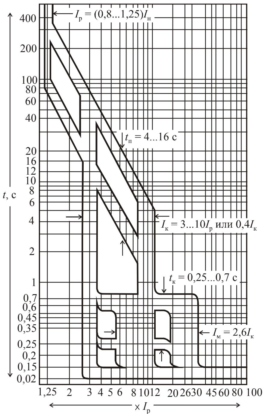
Рис. 3.2. Времятоковая характеристика выключателей переменного тока серии «Электрон» с обратнозависимой от величины тока выдержкой времени в зоне токов перегрузки
