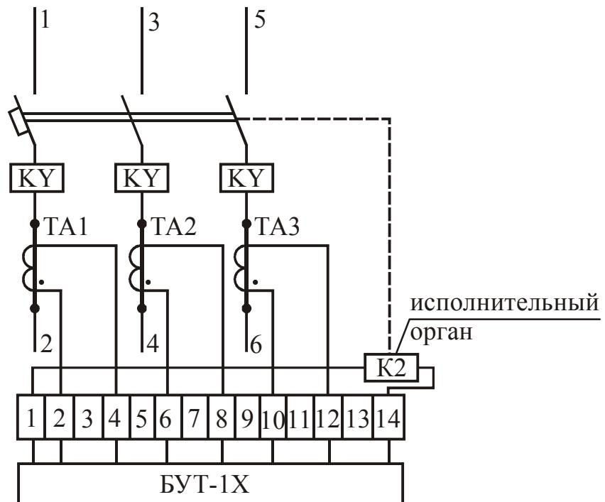
Рис. 2.16. Схема электрическая принципиальная выключателей с максимальным расцепителем переменного тока и электромагнитными расцепителями KY
