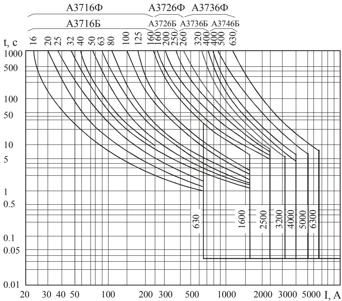
*Рис. 5.7. Семейство защитных характеристик выключателей А3700 с комбинированными (термобиметаллическими и электромагнитными) расцепителями в исполнениях токоограничивающем – А3700Б и нетокоограничивающем – А3700Ф*
