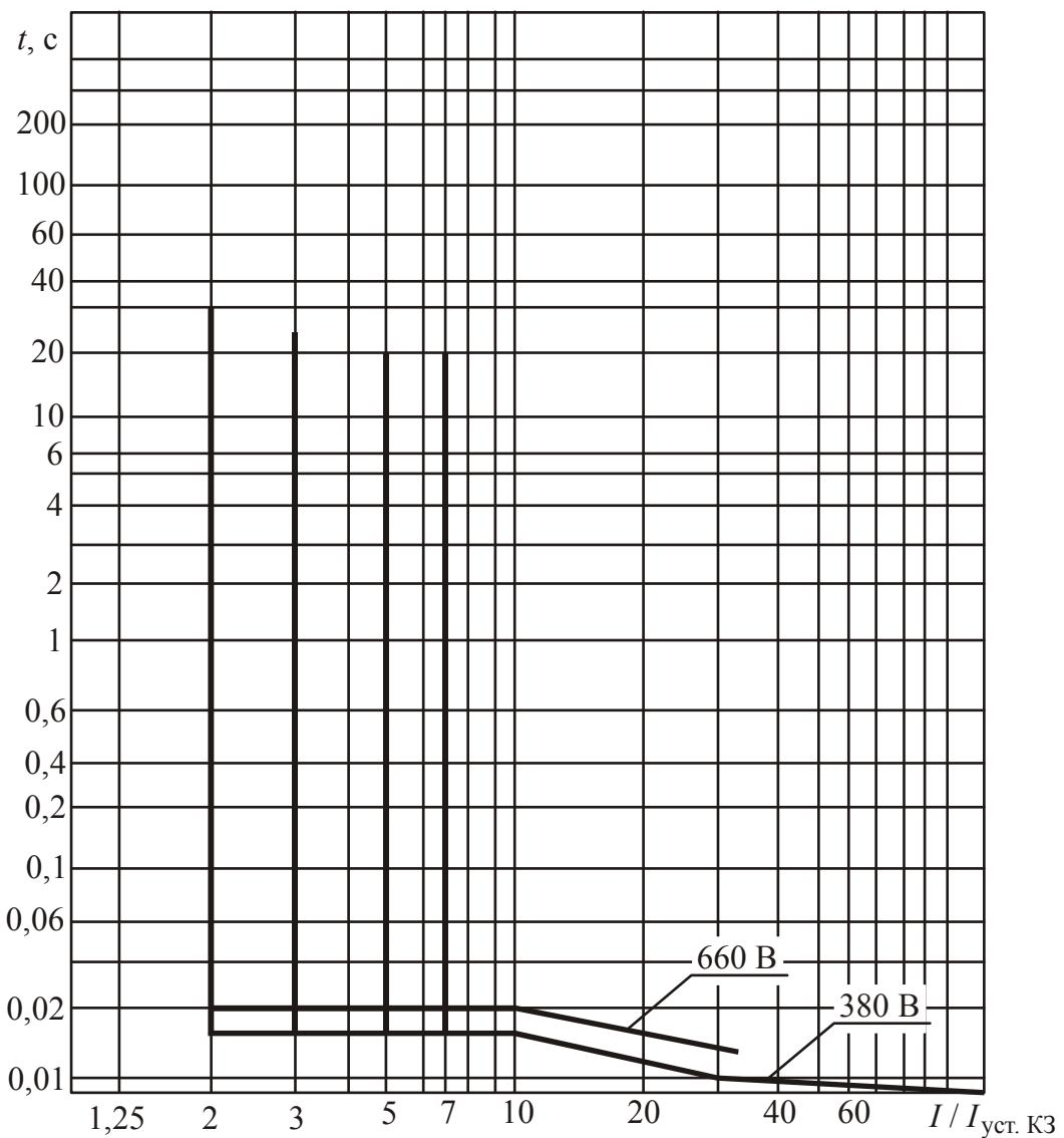
*Рис. 2.139. Времятоковая характеристика отключения автоматического выключателя BA81-41*
