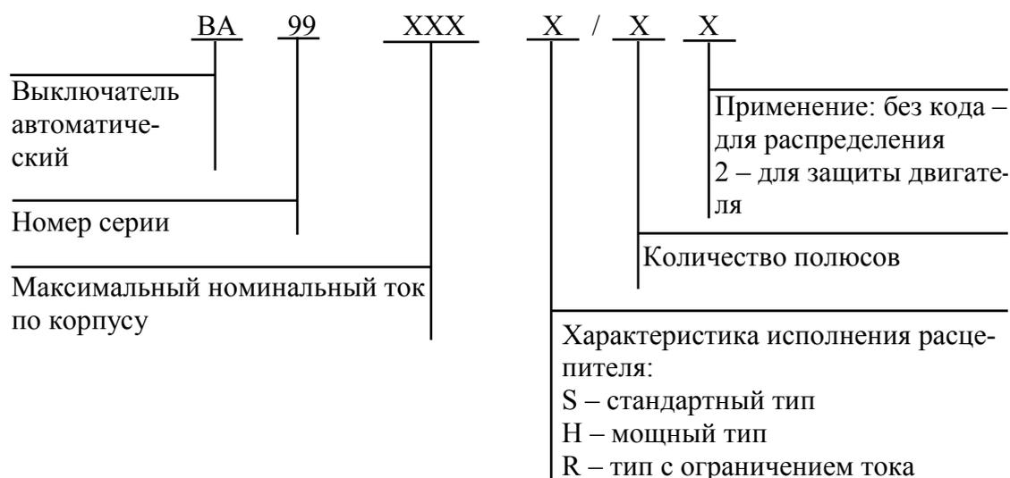
Рис. 2.145. Структура условного обозначения автоматических выключателей ВА99 ЩИТ
