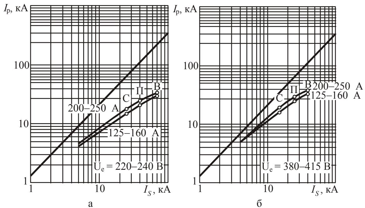
Рис. 2.189. Характеристики токограницения выключателей ВА04 35Про при напряжении 220/240 В (а) и 380/415 В (б):  $I_p$  – фактический ток при отключении (мгновенное значение);  $I_s$  – ожидаемый ток короткого замыкания (действующее значение)
