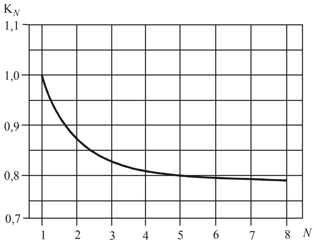
*Рис. 2.100. Нагрузочная способность для параллельно размещенных автоматических выключателей*
