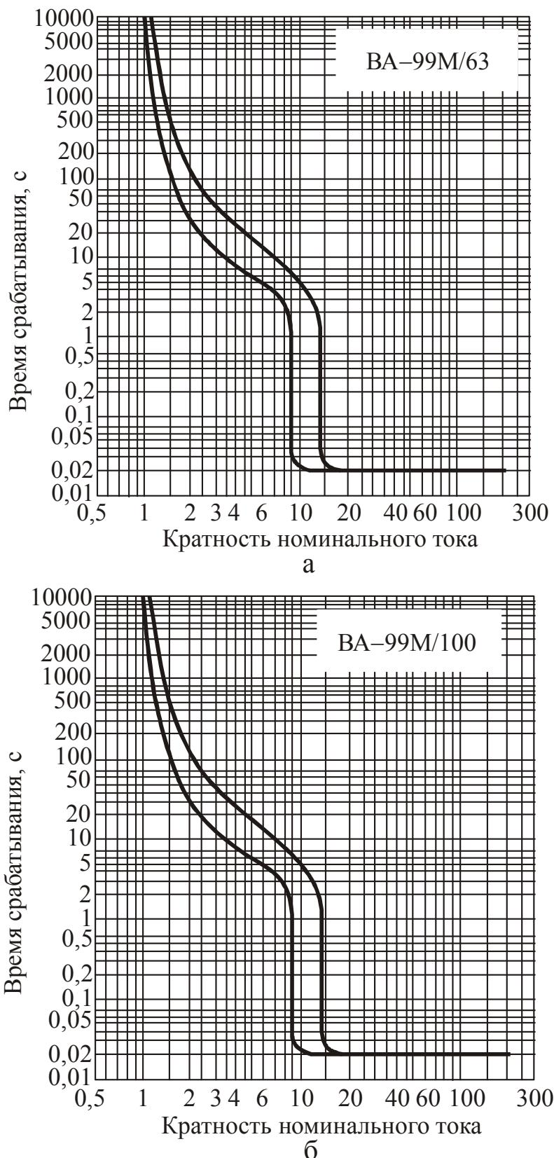
*Рис. 2.152. Времятоковые характеристики отключения выключателей BA-99M/63(а) и BA-99M/100(б)*
