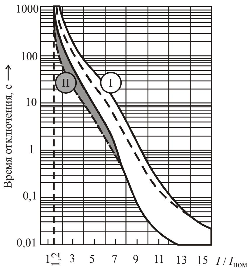
Рис. 2.90. Времяточевые характеристики выключателей ВА13 с гидравлическим замедлением срабатывания с уставкой  $12 I_{ном}$ : I – при температуре окружающей среды  $20^{\circ}\text{C}$ ; II – при температуре окружающей среды  $40^{\circ}\text{C}$
