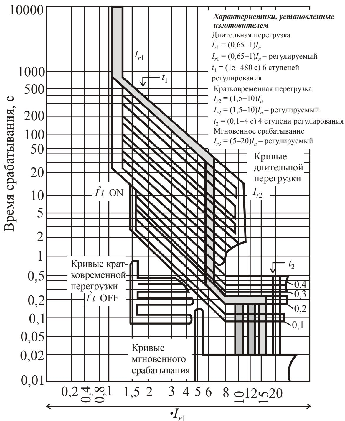
Рис. 2.18. Времятковые характеристики автоматических выключателей ВА-45 с микропроцессором типа L
