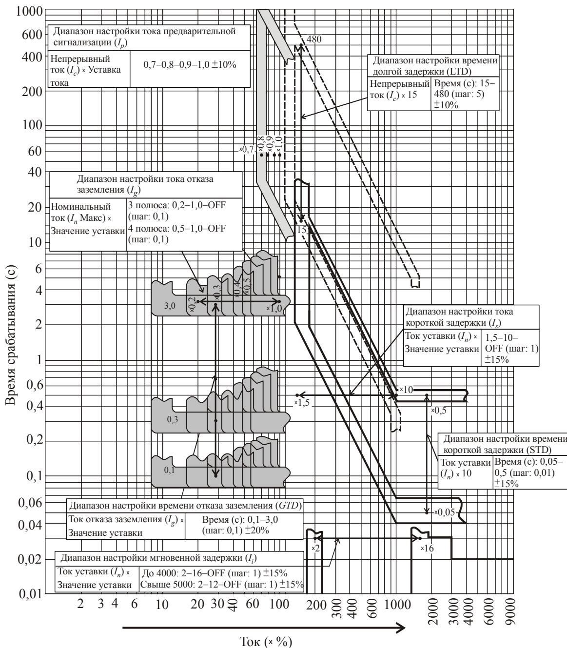
Рис. 2.74. Характеристика блока OCR-III N6, C6, N5, C5
