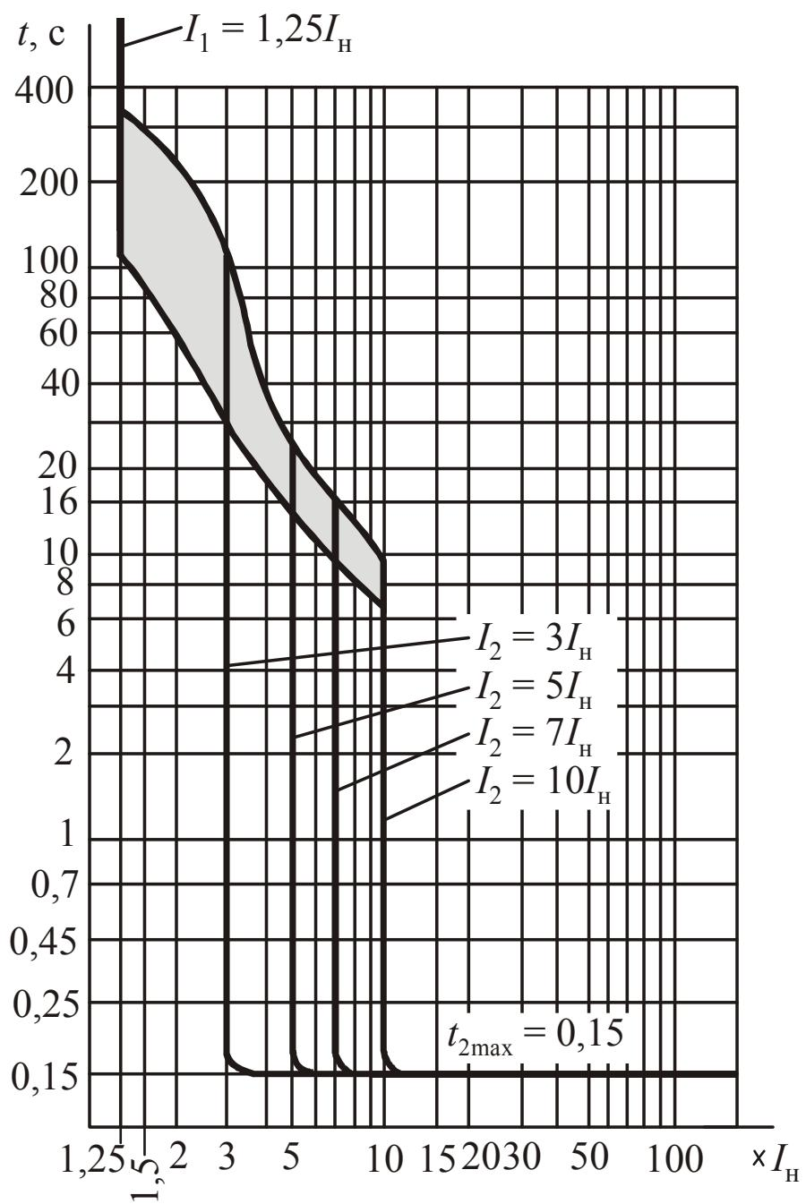
*Рис. 3.13. Времятоковая характеристика выключателей с уставкой времени при  $6I_H$  равной 16 с и положении переключателей S1 – в положении 7, S2 – в положении 11*
