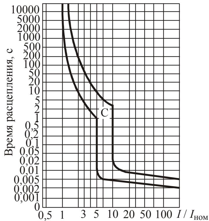
Рис. 2.167. Защитная характеристика автоматических выключателей BA-103 с С-типом электромагнитных расцепителей
