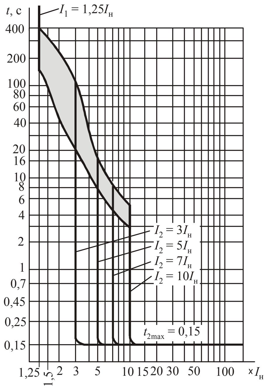
*Рис. 3.12. Времятоковая характеристика выключателей с уставкой времени при  $6I_H$  равной 8 с и положении переключателей S1 – в положении 7, S2 – в положении 11*
