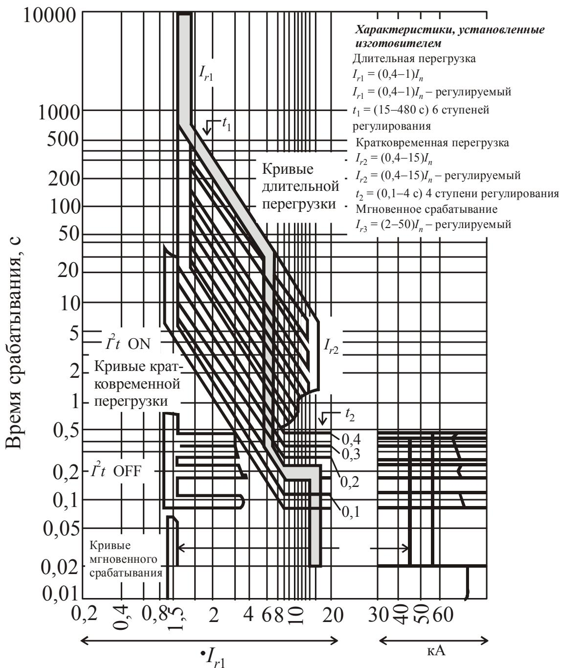
Рис. 2.19. Времяточевые характеристики автоматических выключателей BA-45/2000 с микропроцессором типа M, H
