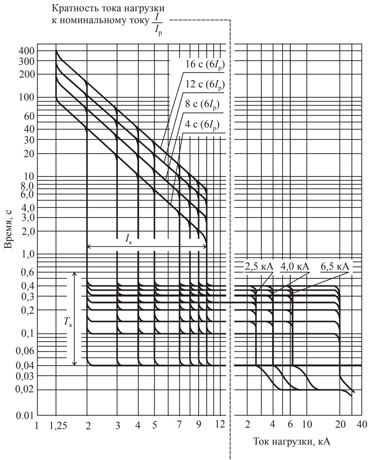
Рис. 5.4. Времятоковая характеристика выключателей переменного тока А3793Б и А3793С, А3794Б и А3794С (пределы отклонений уставок см. в таблице 5.3)
