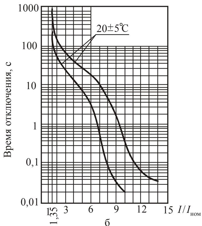
Рис. 7.2. Времятоковые характеристики выключателей АК50Б переменного тока частоты 50 Гц с максимальными расцепителями тока исполнения МГ при нагрузке всех полюсов: а – с уставкой по току  $6 I_{\text{ном}}$ ; б – с уставкой по току  $12 I_{\text{ном}}$
