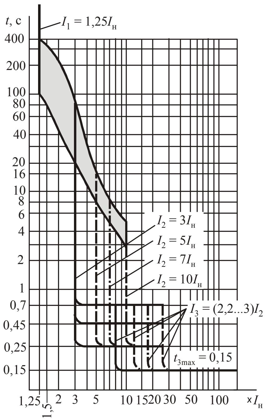
Рис. 3.10. Времяточная характеристика выключателей с уставкой времени при  $6I_H$  равной 16 с и положении переключателей  $S1$  – в положении 6,  $S2$  – в положении 11
