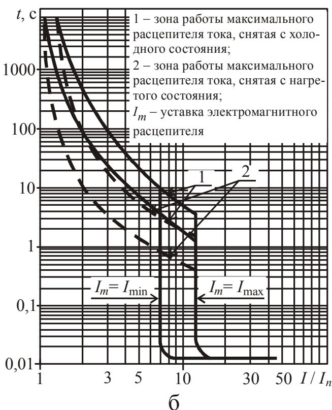
Рис. 2.122. Времятоковые характеристики автоматических выключателей BA57Ф35, BA57-35: а – номинальные токи тепловых максимальных расцепителей тока 16; 20; 25; 31,5; 40; 50 А; б – номинальные токи тепловых максимальных расцепителей тока 63; 80 А
