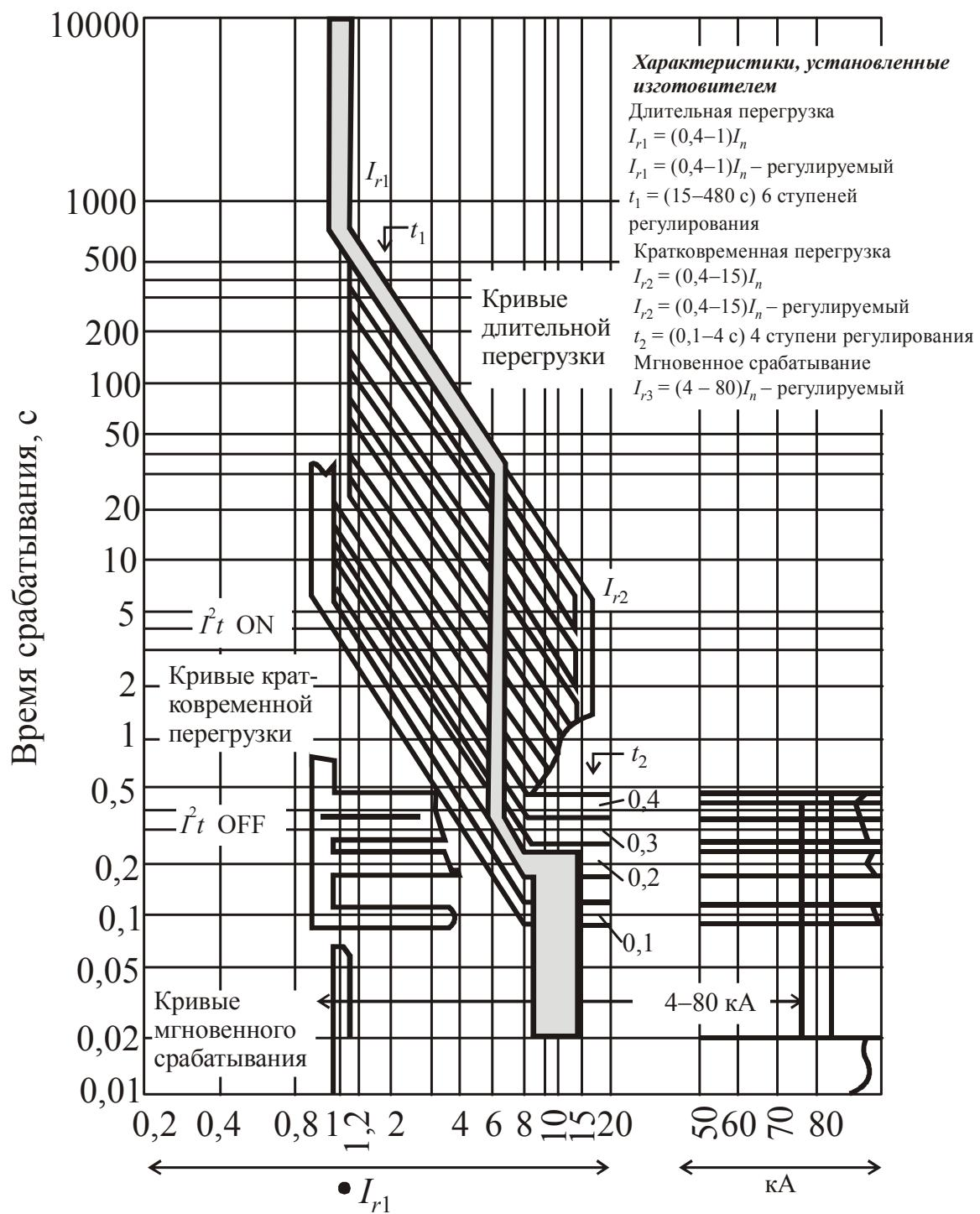
Рис. 2.20. Времяточевые характеристики автоматических выключателей BA-45/3200 с микропроцессором типа М, Н
