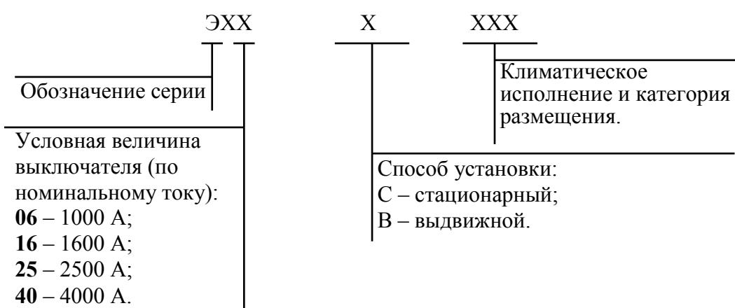
Рис. 3.1. Структура условного обозначение автоматических выключателей серии «Электрон»
