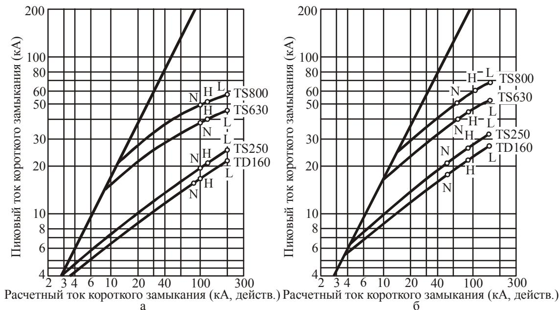
Рис. 2.194. Характеристики токоограничения автоматических выключателей BA-СЭЩ-TD/TS при напряжении 220/240 В (а) и 380/415 В (б)
