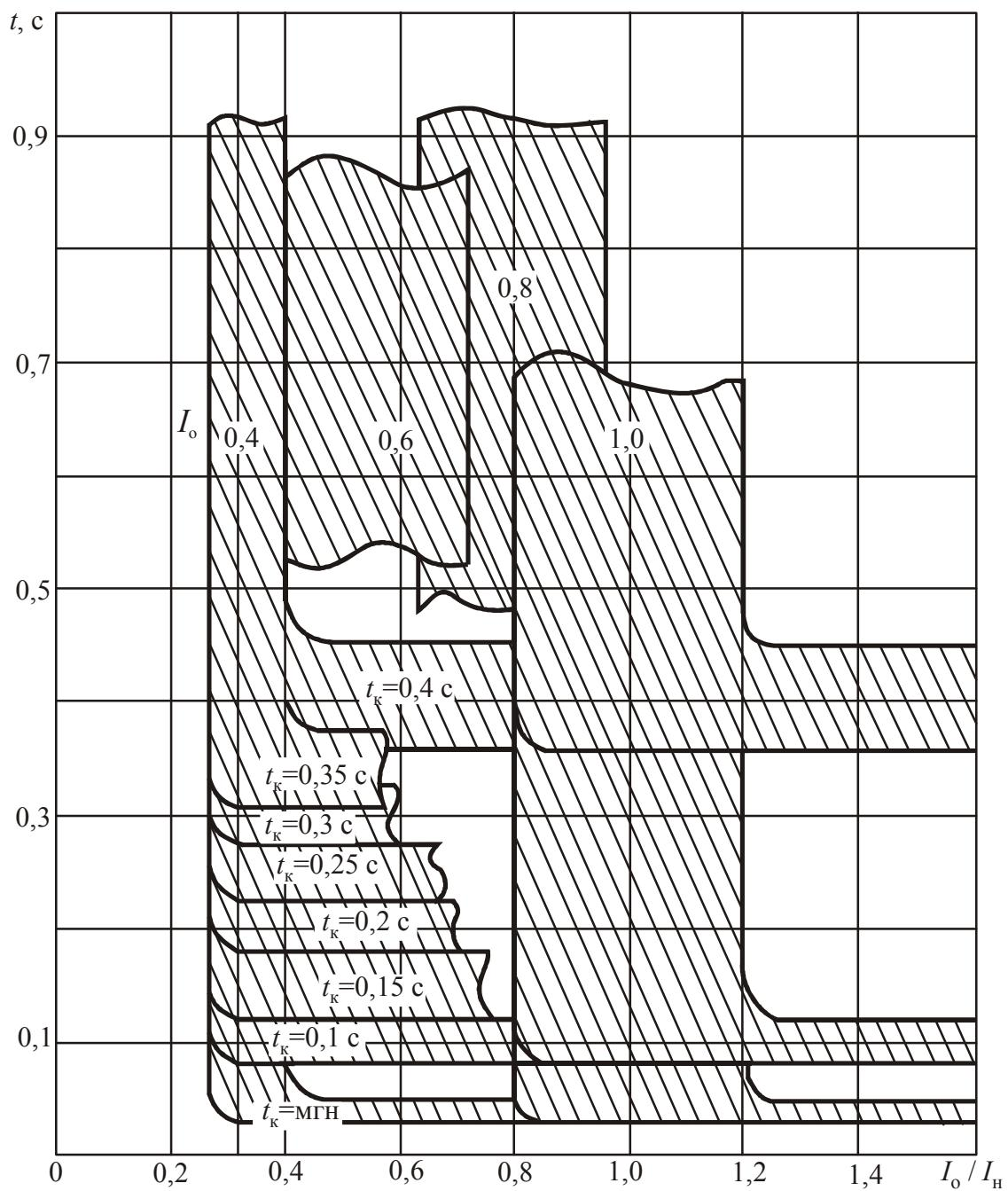
Рис. 2.36. Время-токовая характеристика выключателей переменного тока BA53 43 и BA55 43 с защитой от однофазных замыканий, пределы отклонений уставок см. таблицу 2.14
