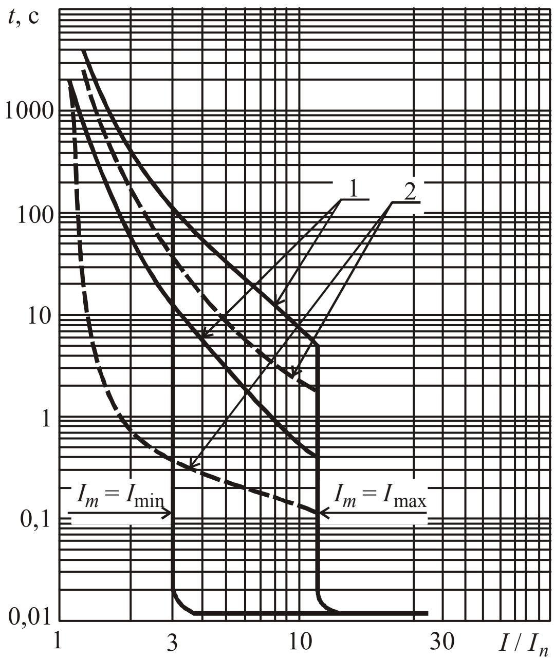
Рис. 2.128. Времятоковые характеристики выключателей серии ВА57Ф35 на токи 16; 20; 25; 31,5; 40; 50 А: 1 – зона работы теплового максимального расцепителя тока, снятая с холодного состояния; 2 – зона работы теплового максимального расцепителя тока, снятая с нагретого состояния;  $I_m$  – уставка электромагнитного расцепителя тока КЗ
