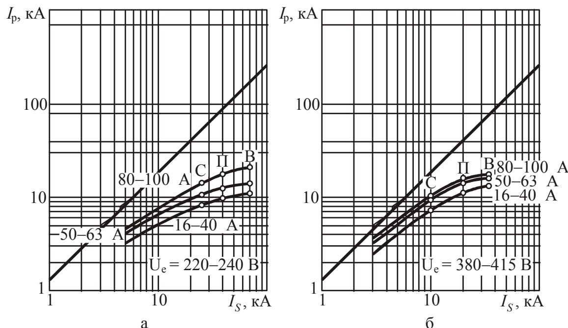
Рис. 2.188. Характеристики токограничения выключателей ВА04 31Про при напряжении 220/240 В (а) и 380/415 В (б):  $I_p$  – фактический ток при отключении (мгновенное значение);  $I_s$  – ожидаемый ток короткого замыкания (действующее значение)
