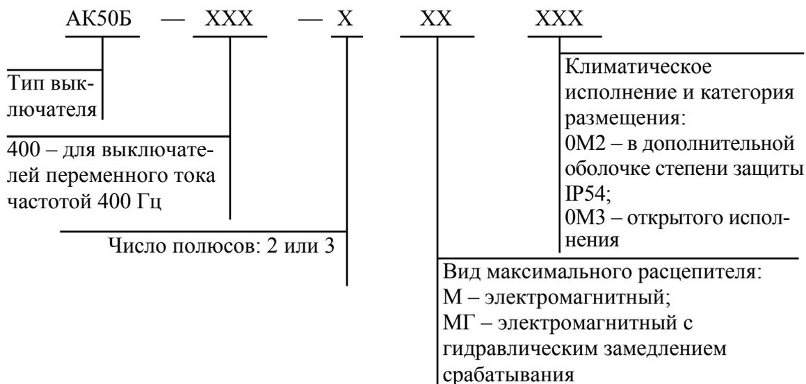
Рис. 7.1. Структура условного обозначения выключателей серии АК50Б
