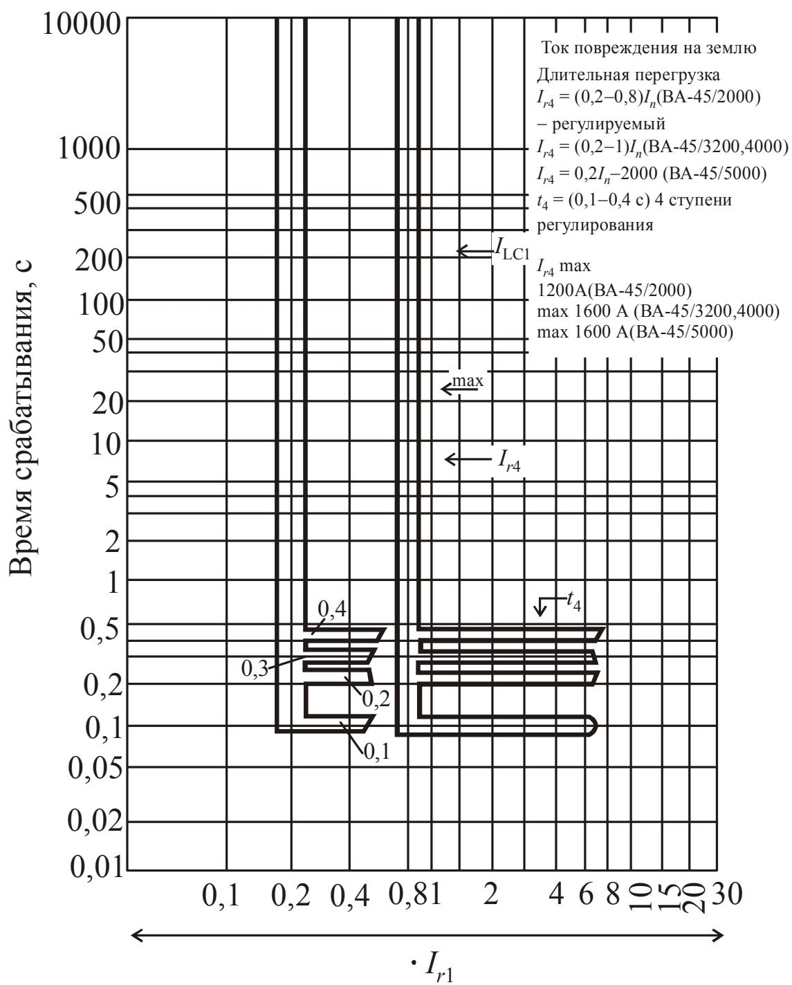
Рис. 2.23. Характеристики защиты от замыканий на землю автоматических выключателей BA-45 с микропроцессором типа М, Н
