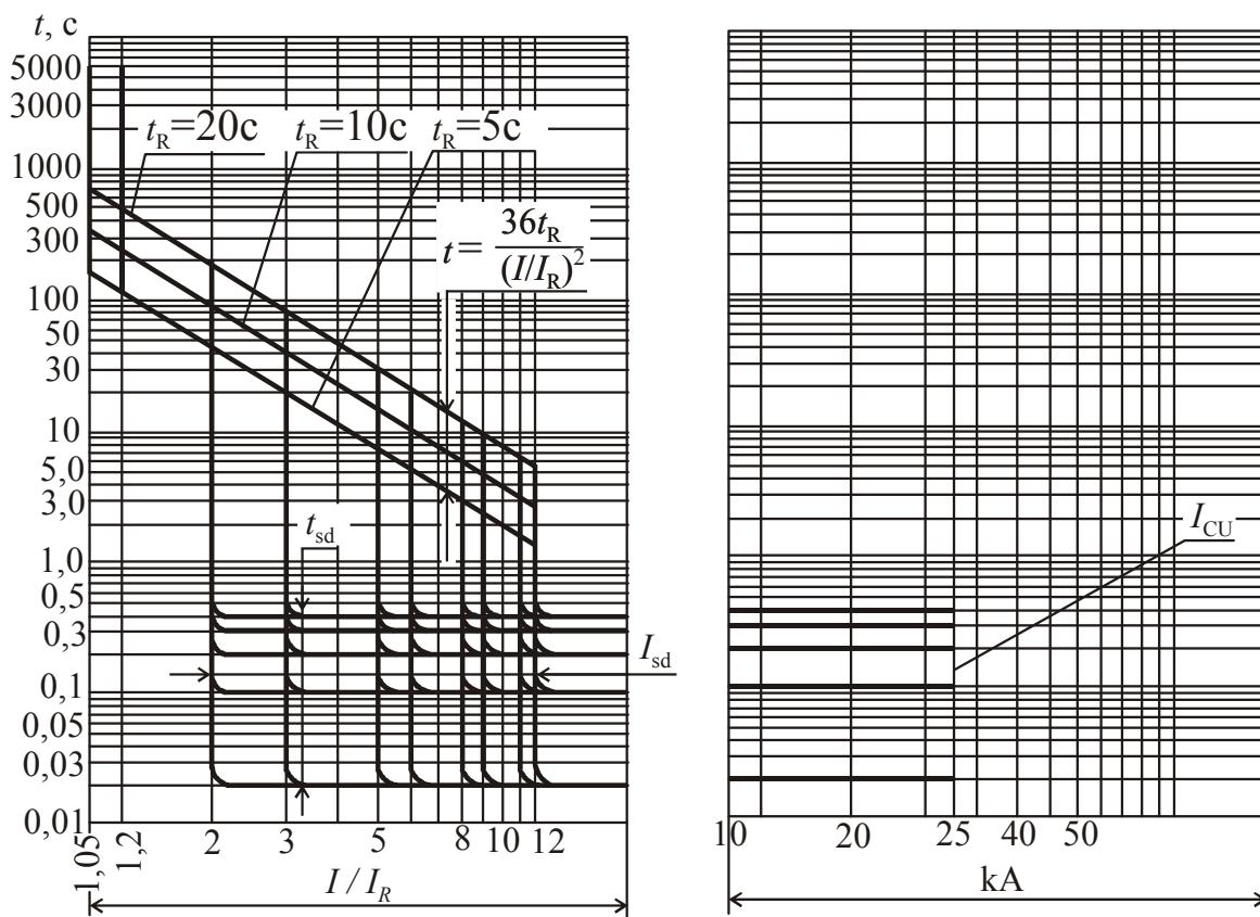
Рис. 2.8. Времятоковая характеристика выключателей переменного тока BA08-0403С, BA08-0633С, BA08-0803С с электронным (аналоговым) расцепителем тока
