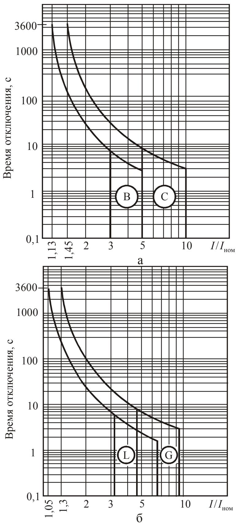
Рис.6.2. Времяточковые характеристики автоматических выключателей BM40:
