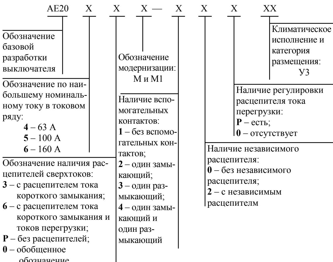
*Рис. 9.1. Структура условного обозначения выключателей AE20*
