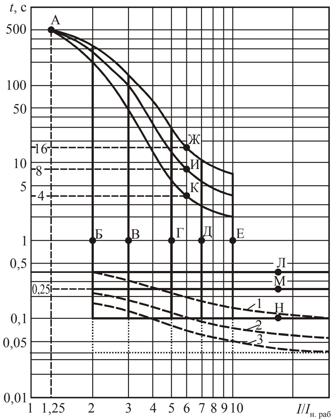
Рис. 5.6. Защитные характеристики автоматических выключателей A3700
