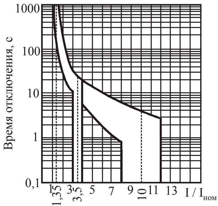
Рис. 8.7. Времятковые характеристики выключателей АП50Б с номинальными токами расцепителей 6,3...50 А при температуре окружающей среды  $20\pm 5^{\circ}\text{C}$ , в холодном состоянии
