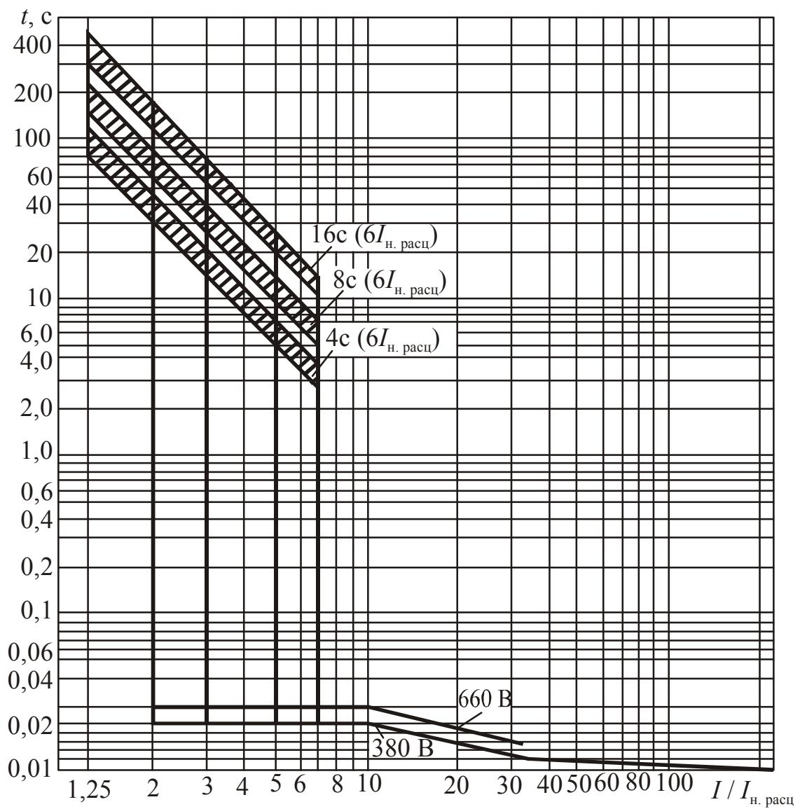
Рис. 2.47. Времятоковая характеристика автоматических выключателей BA53-41 с номинальным током полупроводникового расцепителя 1000 А
