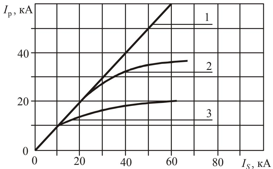
Рис. 2.190. Характеристики токоограничения выключателей ВА57 при напряжении 380 В: 1 – характеристика без ограничения тока; 2 – характеристика с ограничением тока для ВА57-35, ВА57-39; 3 – характеристика с ограничением тока для ВА57-31;  $I_s$  – ожидаемый ток короткого замыкания (действующее значение);  $I_p$  – фактический ток при отключении (мгновенное значение)
