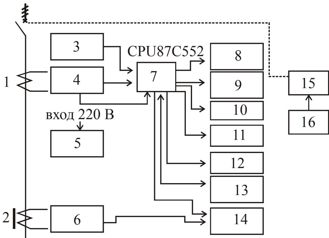
*Рис. 2.24. Структурная схема функционирования микропроцессорных блоков выключателей ВА-45:*
