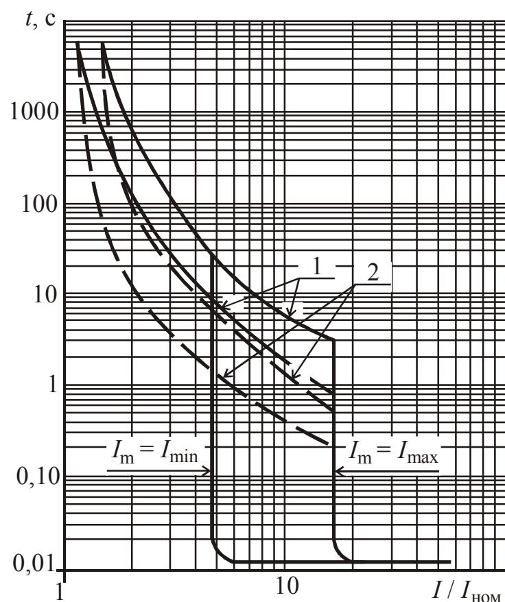
Рис. 2.81. Времятоковые характеристики выключателей BA04–36 на ток 125 А: 1 – зона работы теплового максимального расцепителя тока, снятая с холодного состояния; 2 – зона работы теплового максимального расцепителя тока, снятая с нагретого состояния;  $I_m$  – уставка электромагнитного расцепителя тока короткого замыкания
