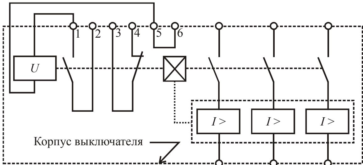
Рис. 2.92. Электрическая схема выключателя BA13
