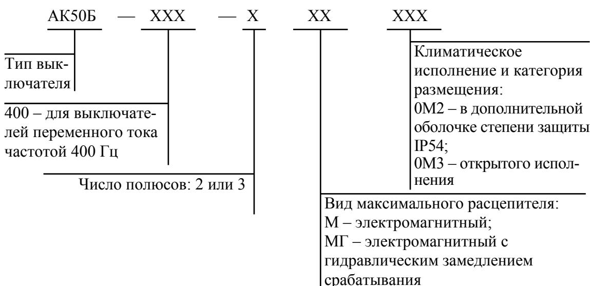
*Рис. 7.1. Структура условного обозначение выключателей серии АК50Б*
