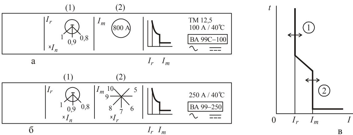
Рис. 2.156. Панель настройки термоэлектромагнитных расцепителей выключателей BA-99C/100 (а) и BA-99C/160/250 (б), схема защитных характеристик выключателей серии BA-99C (в)
