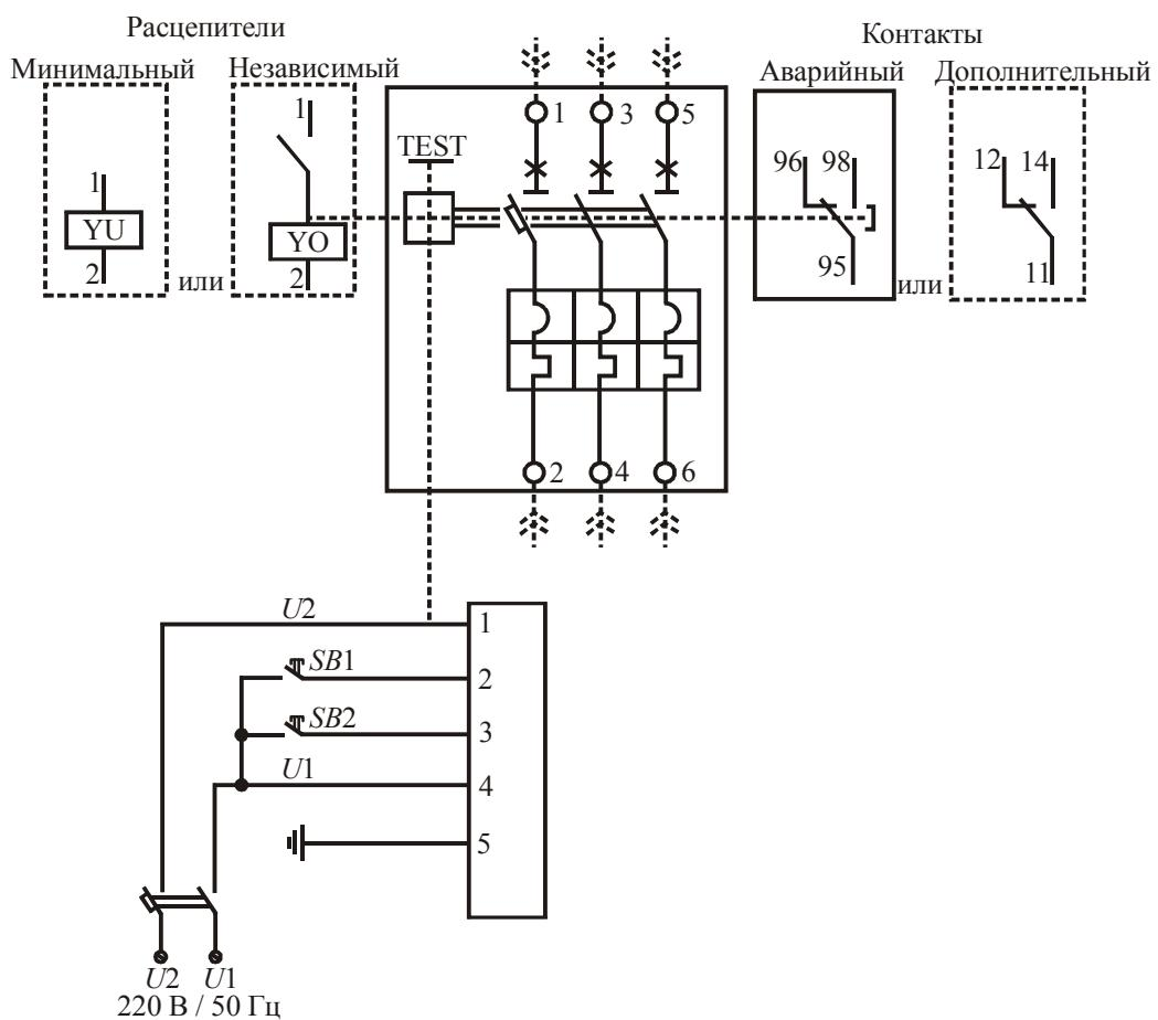
Рис. 2.161. Схема электрическая принципиальная автоматических выключателей BA-99, BA-99C с термоэлектромагнитными расцепителями и дополнительными устройствами: SB1, SB2 – кнопка с пружинным возвратом; U1 – фаза; U2 – нуль; кнопка SB1 служит для приведения рукоятки автомата в положение ON; кнопка SB2 служит для приведения рукоятки автомата в положение OFF
