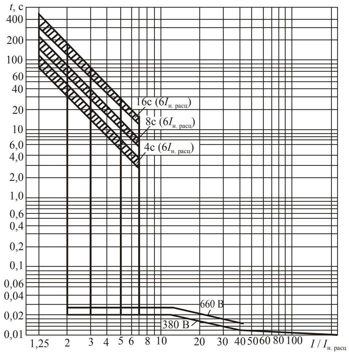
Рис. 2.46. Времятоковая характеристика автоматических выключателей BA53-41 с номинальным током полупроводникового расцепителя 800 А
