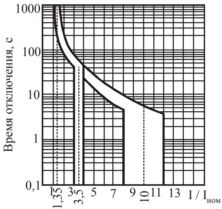
Рис. 8.8. Времятковые характеристики выключателей АП50Б с номинальным током расцепителей 63 А при температуре окружающей среды  $20\pm 5^{\circ}\text{C}$ , в холодном состоянии
