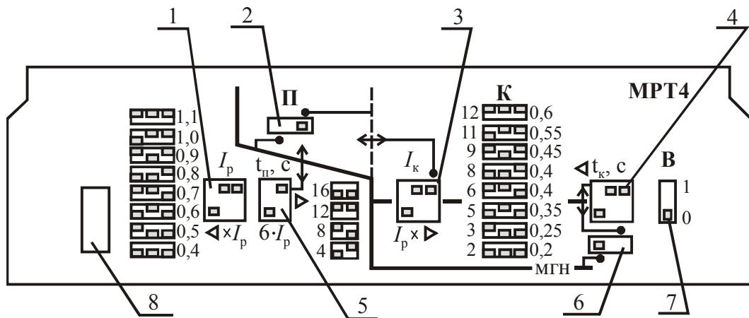
*Рис. 4.1. Лицевая панель блока МРТ4 выключателей переменного тока:*
