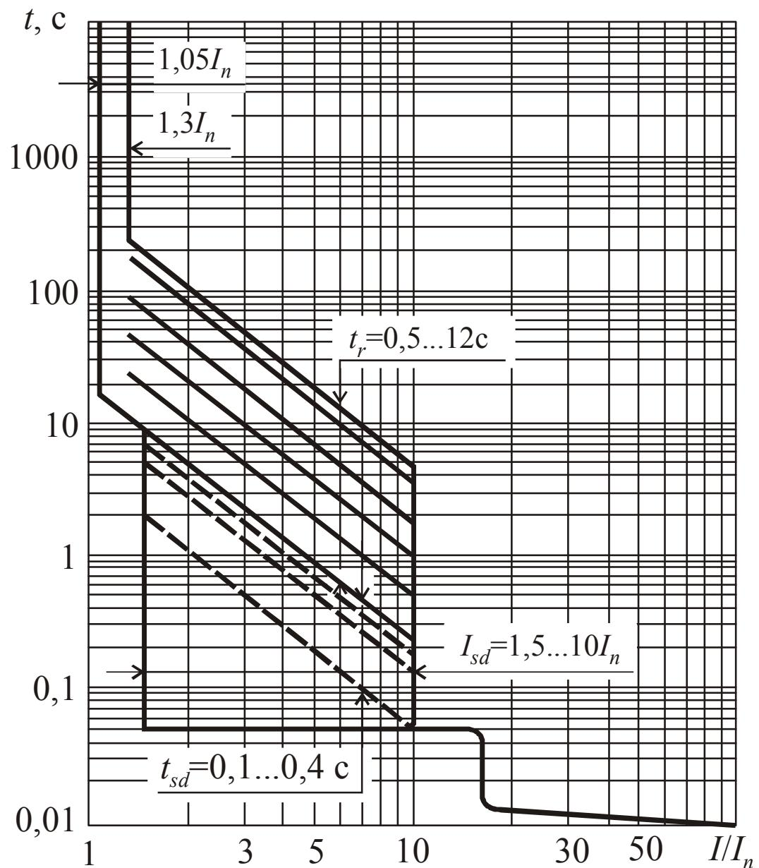
Рис. 2.43. Времятоковые характеристики выключателей ВА57-39-35:  $I_n$  – номинальный ток выключателя;  $I_{sd}$  – ток срабатывания в зоне токов короткого замыкания с обратнозависимой времятоковой характеристикой ( $I_n^2 t = \text{const}$ ) или независимой задержкой срабатывания;  $t_r$  – время срабатывания в зоне токов перегрузки при  $6I_n$ ;  $t_{sd}$  – время срабатывания в зоне токов короткого замыкания
