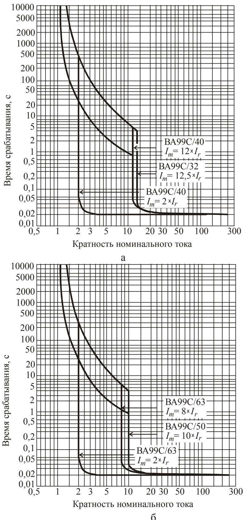
Рис. 2.158. Времятоковые характеристики автоматических выключателей
