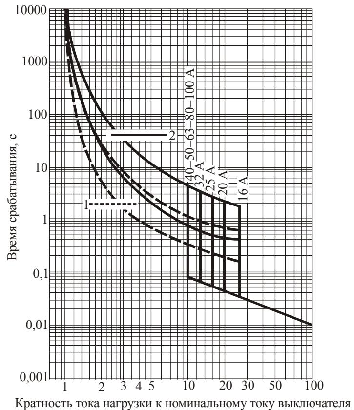
*Рис. 2.76. Времятиковые характеристики отключения выключателей BA04 31 Про ( $C-P-B$ ,  $I_{ном} = 16-100\text{ A}$ ) при температуре окружающей среды  $40^{\circ}\text{C}$ : 1 – зона работы от «горячего» состояния теплового расцепителя; 2 – зона работы от «холодного» состояния теплового расцепителя*
