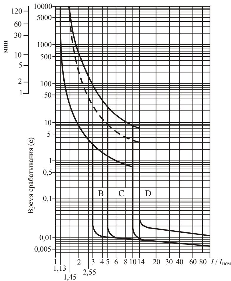
Рис. 2.101. Времятоковые характеристики отключения выключателей BA47-29 при температуре окружающей среды +30 °C. Пунктирная линия – верхняя граница времятоковой характеристики для автоматических выключателей с номинальным током  $I_{\text{ном}} \leq 32 \text{ A}$
