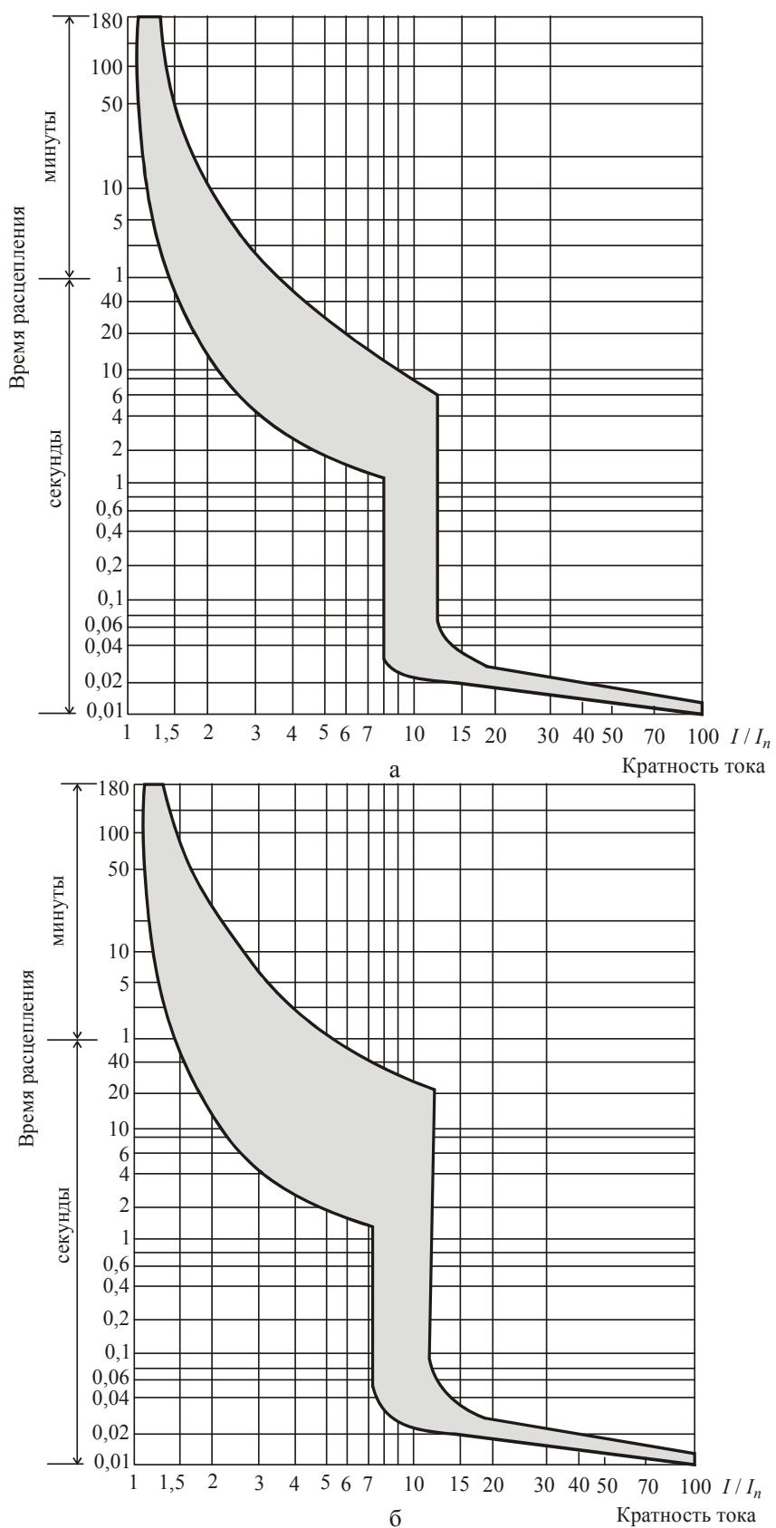
Рис. 2.149. Времятоковые характеристики отключения выключателей
