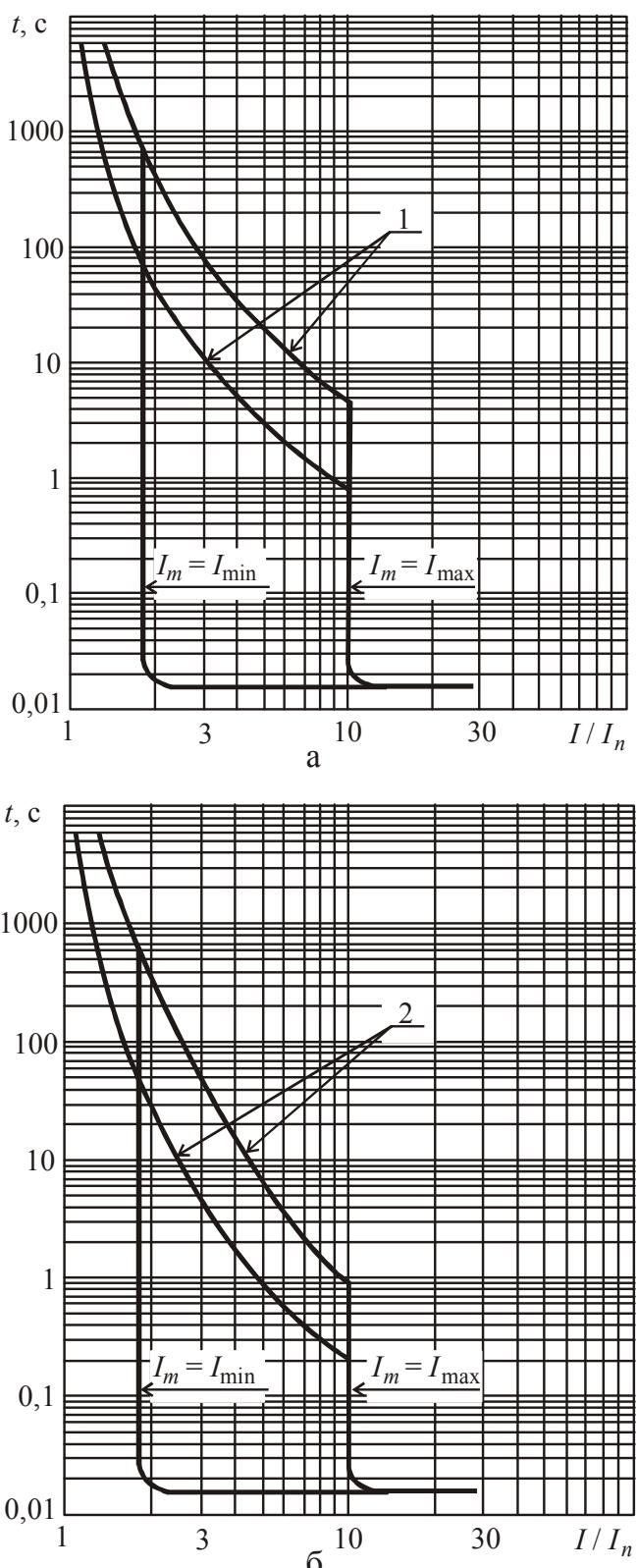
Рис. 2.132. Времяточевые характеристики выключателей серии ВА57-39, снятые с холодного (а) и нагреветого (б) состояния: 1, 2 – зоны работы теплового максимального расцепителя тока;  $I_m$  – уставка электромагнитного расцепителя тока КЗ
