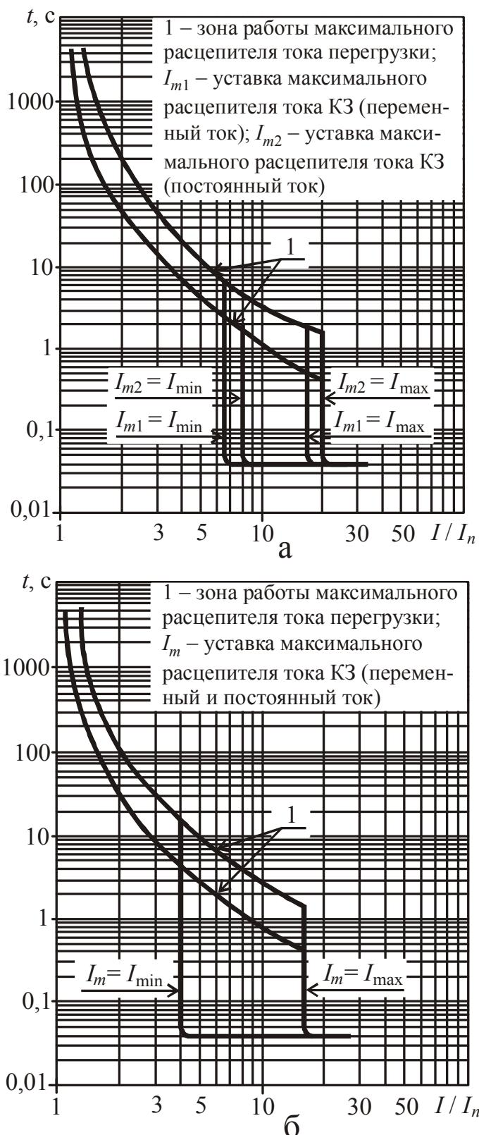
Рис. 2.121. Времятоковые характеристики выключателей ВА57-31 с холодного состояния: а – номинальные токи тепловых максимальных расцепителей тока 50; 63 А; б – номинальные токи тепловых максимальных расцепителей тока 80; 100 А
