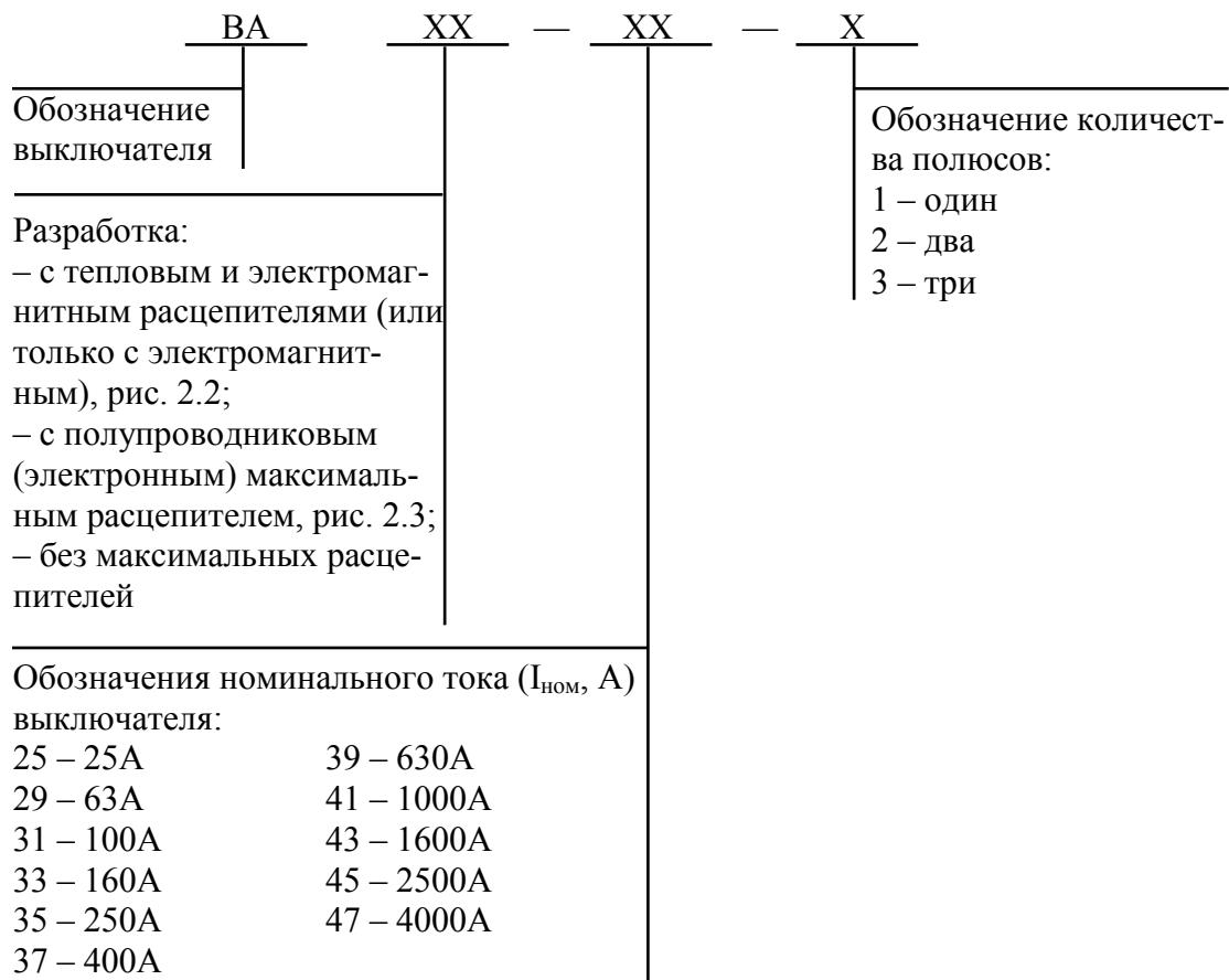
Рис. 2.1. Упрощенная структура условного обозначения автоматических выключателей серии ВА
