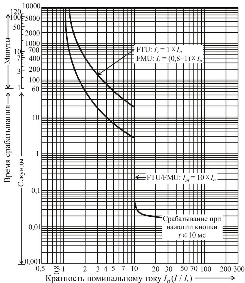
Рис. 2.174. Времятковые характеристики автоматических выключателей TS160 с расцепителями FTU, FMU на токи 100–160 А
