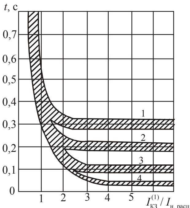
Рис. 2.51. Характеристика защиты от однофазных КЗ выключателей с полупроводниковым расцепителем: селективных BA55 и BA75 с уставками времени срабатывания отсечки 0,3 с (кривая 1); 0,2 с (кривая 2); 0,1 с (кривая 3) и неселективных BA53, BA54 (кривая 4)
