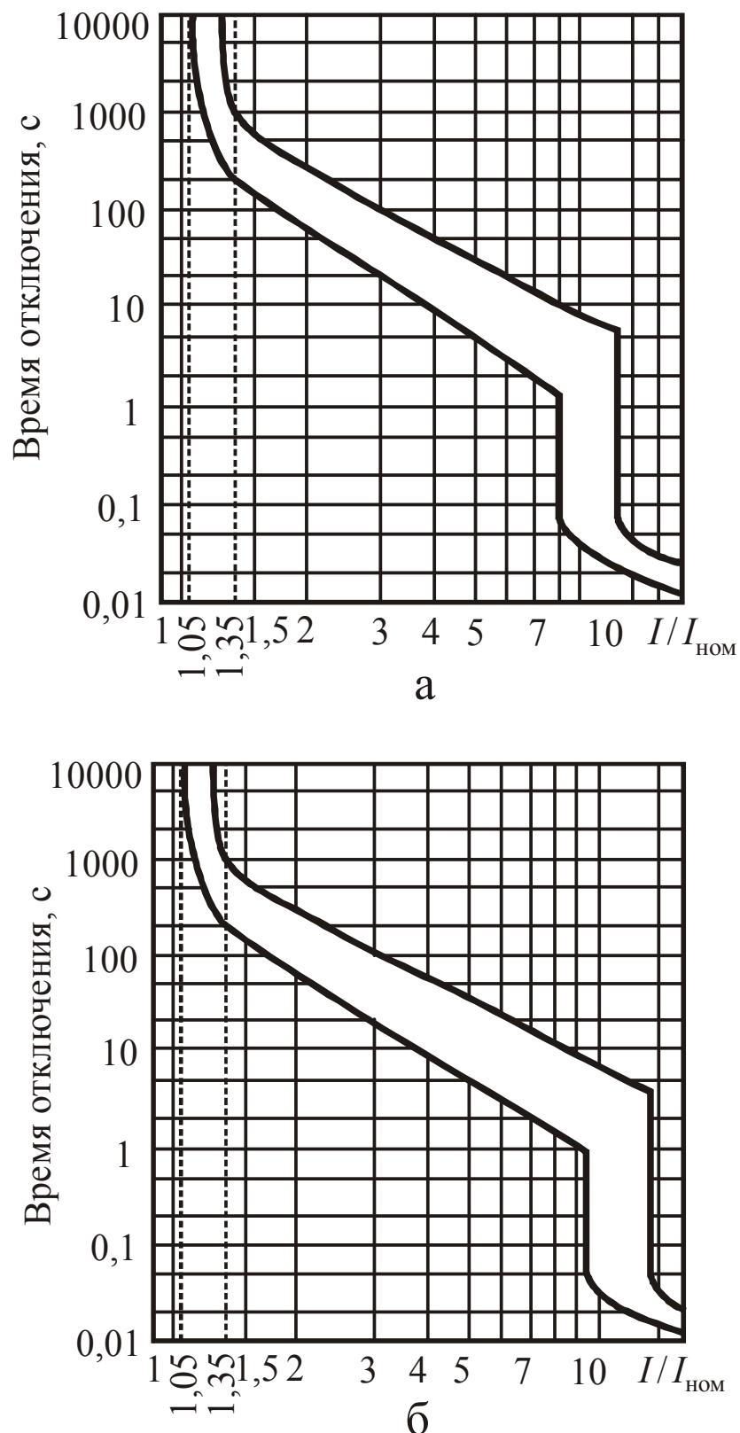
Рис. 9.3. Времятоковые характеристики выключателей AE2040, AE2050М с расцепителями тока перегрузки без регулировки и температурной компенсации и расцепителями тока КЗ: а – с уставкой  $10 \cdot I_{\text{ном}}$ ; б – с уставкой  $12 \cdot I_{\text{ном}}$
