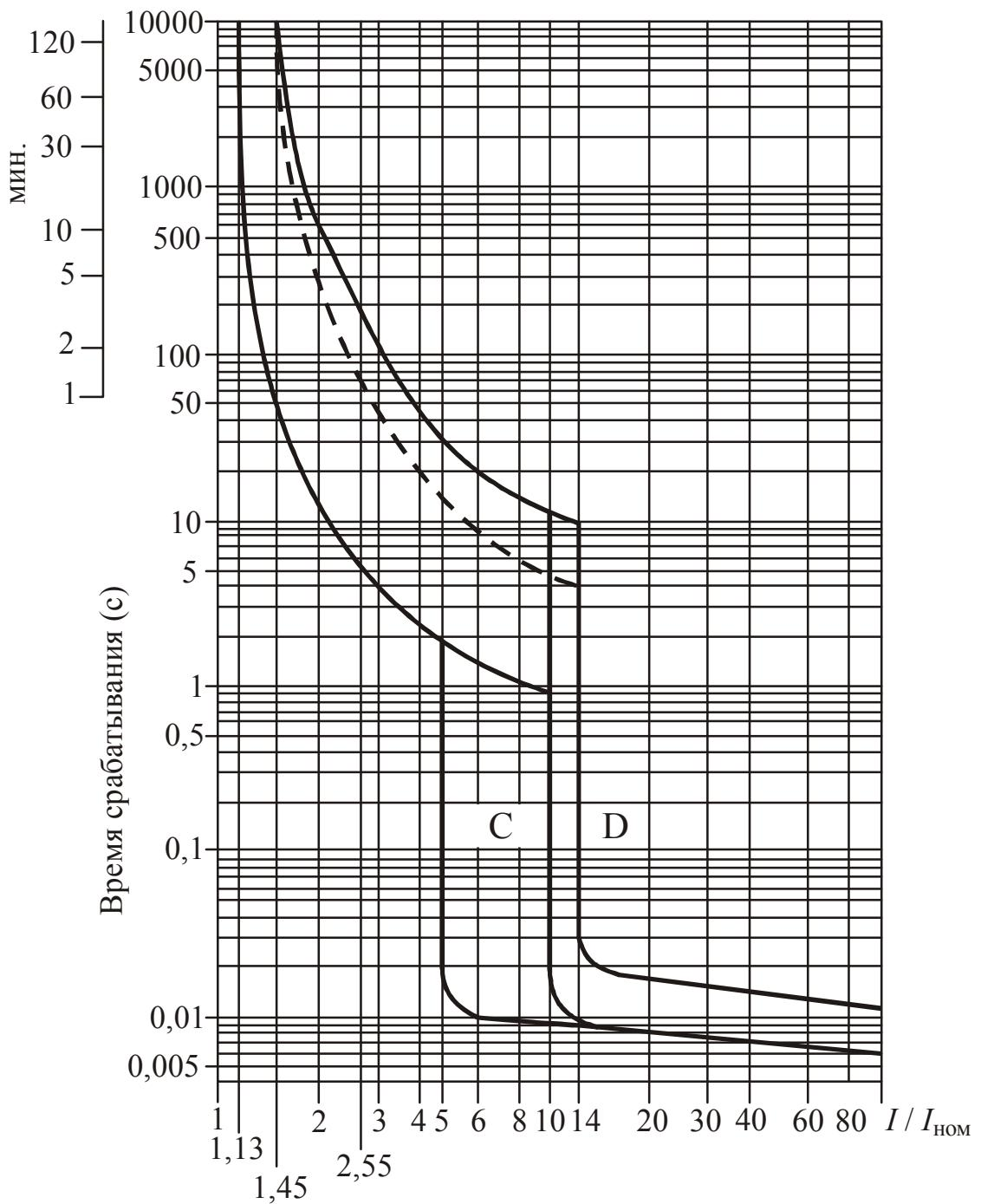
*Рис. 2.103. Времятоковые характеристики отключения выключателей BA47-100 при температуре окружающей среды +30 °C. Пунктирная линия – верхняя граница времяточевой характеристики для автоматических выключателей с номинальным током  $I_{ном} \leq 32 A$*
