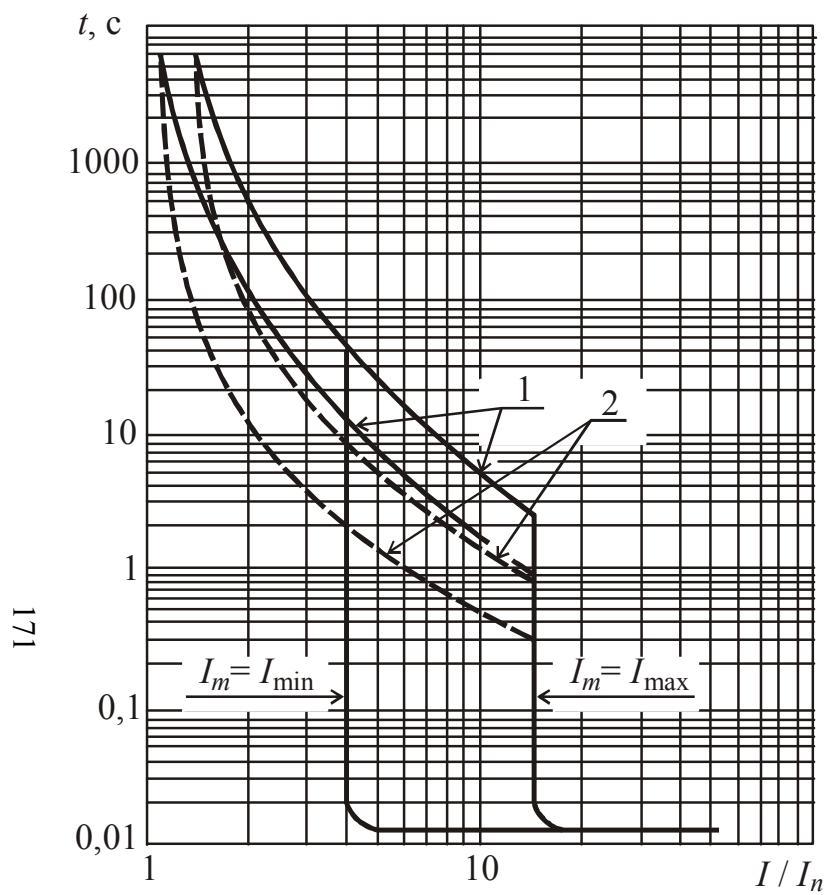
Рис. 2.109. Времятоковые характеристики выключателя BA51-35 на ток 100 А: 1 – зона работы теплового максимального расцепителя тока, снятая с холодного состояния; 2 – зона работы теплового максимального расцепителя тока, снятая с нагреветого состояния;  $I_m$  – уставка электромагнитного расцепителя тока короткого замыкания
