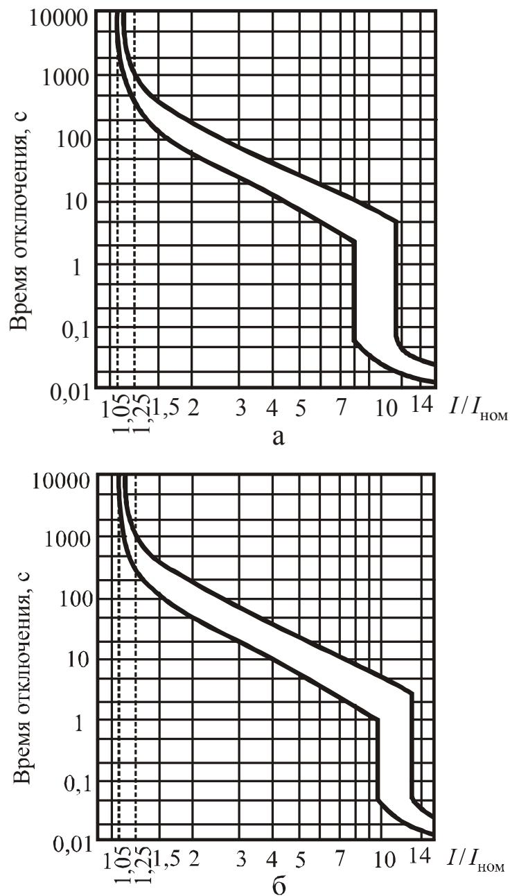
Рис.9.2. Времятоковые характеристики выключателей АЕ2040, АЕ2050М с расцепителями тока перегрузки с регулировкой и температурной компенсацией и расцепителями тока КЗ: а – с уставкой  $10 \cdot I_{\text{ном}}$ ; б – с уставкой  $12 \cdot I_{\text{ном}}$
