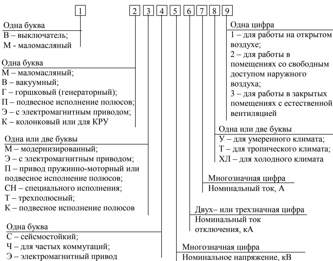
Рис. 7.2. Структура условного обозначения выключателей высокого напряжения
