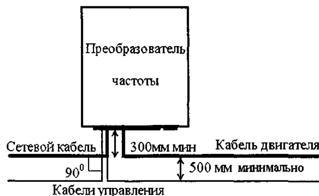
Рис. 15 Схема монтажа преобразователя частоты
