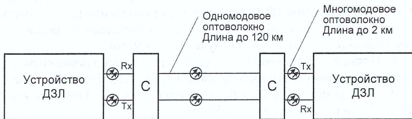
Рис. 2.9. Подключение полукомплектов с использованием медиаконвертеров: С — оптический конвертер
