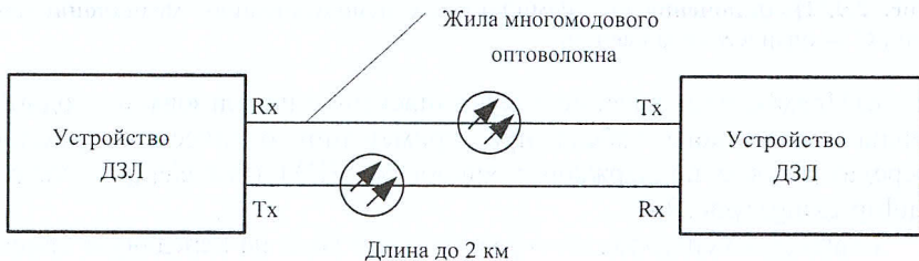
Рис. 2.6. Прямое подключение полукомплектов с использованием двух жил многомодового ОК
