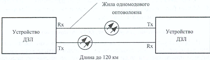
Рис. 2.7. Прямое подключение полукомплектов с использованием двух жил одномодового ОК
