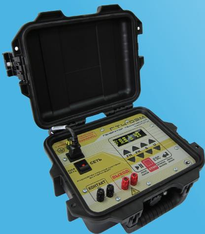
ООО «Радиоэлектронные системы» производит генератор технической частоты ГТЧ-03М, предназначенный для испытания, наладки и технического обслуживания устройств релейной защиты и противоаварийной автоматики. Генератор обеспечивает автоматизированное измерение частоты и времени срабатывания устройств защиты при плавном и скачкообразном изменении частоты. ГТЧ-03М внесен в реестр средств измерений и имеет сертификат соответствия РосТест.
